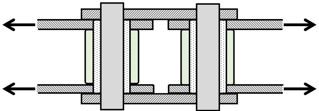
チェーンは応力ではなく、発生荷重とカタログ記載の最小引張強さの比較により評価する。
