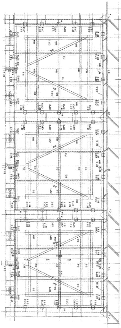
第2図 プローアウトパネル及び取付け架台の概略図
