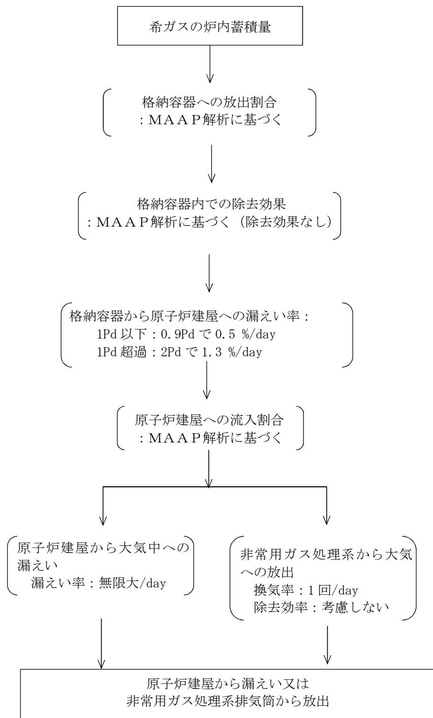
図 14 希ガスの大気放出過程
