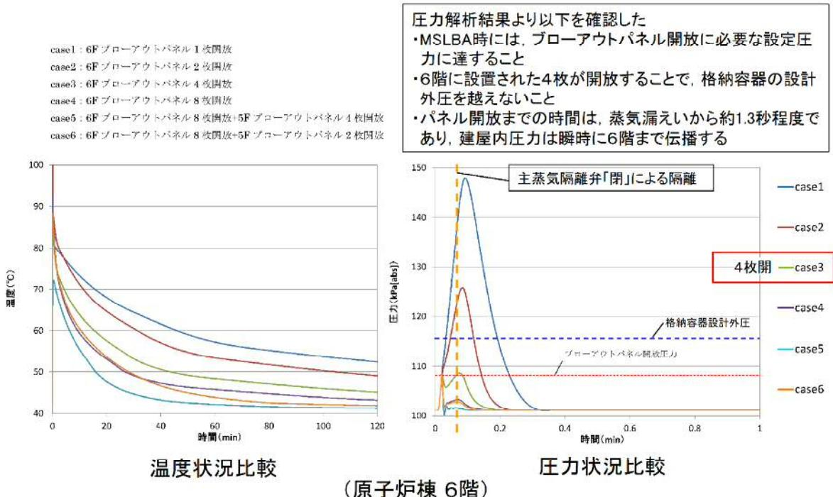
第 2-6 図 プローアウトパネル作動枚数による温度及び圧力状況比較
