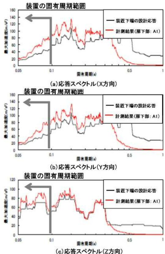
第3-3図 扉開 下部測定結果（試験 No. 6）
