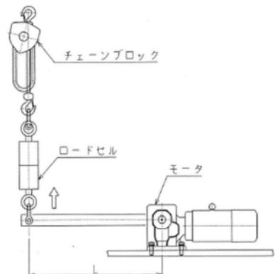
電動機ブレーキトルク試験概略図
