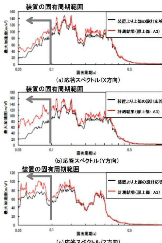
第3-4図 扉開 上部測定結果（試験 No. 6）
