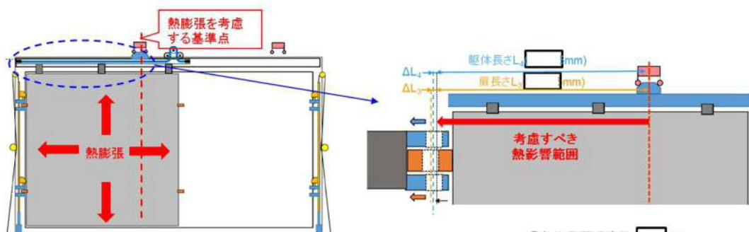
・SUS304の熱膨張係数 $\alpha_1: 1.6 \times 10^{-5}/^{\circ}\text{C}$ , 鉄筋コンクリートの熱膨張係数 $\alpha_2: 1.0 \times 10^{-5}/^{\circ}\text{C}$
