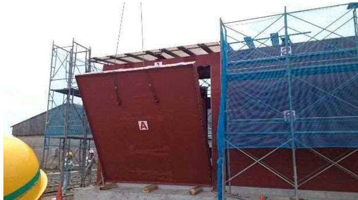
第2-14図 実機大ブローアウトパネル開放試験
