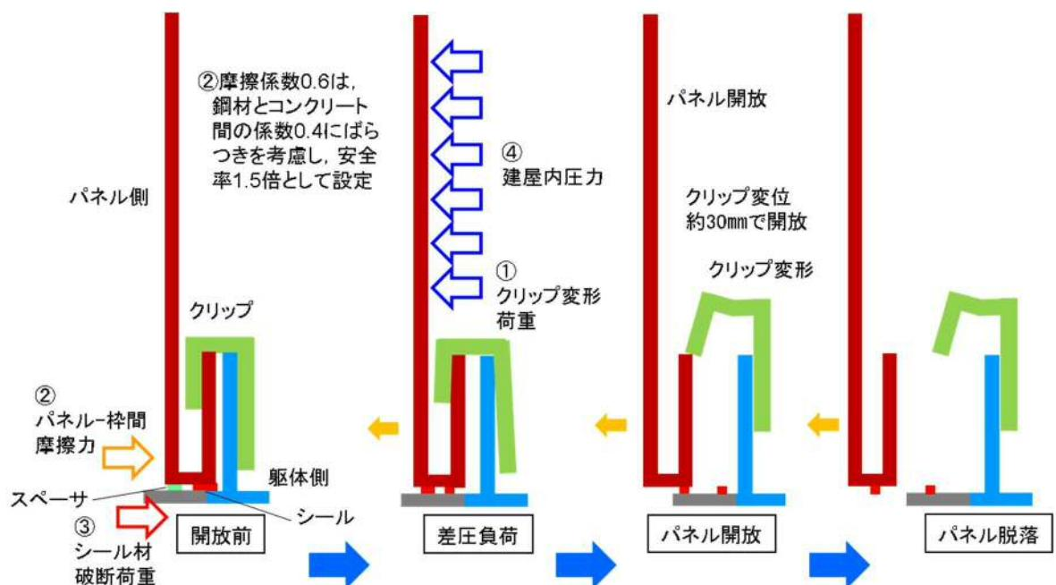
第2-3図 プローアウトパネル開放のメカニズム
