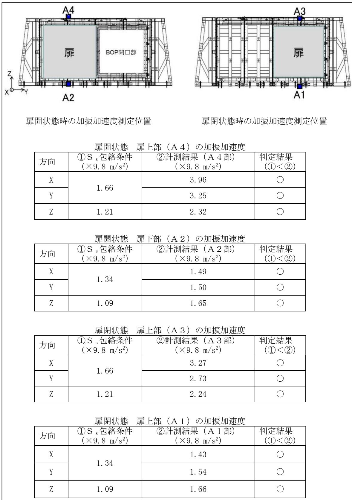
図7-2 3次元加振試験時の加振加速度の妥当性
