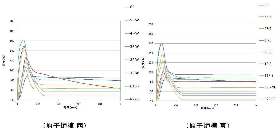
第2-8図 対策後の温度状況比較（最高温度）
