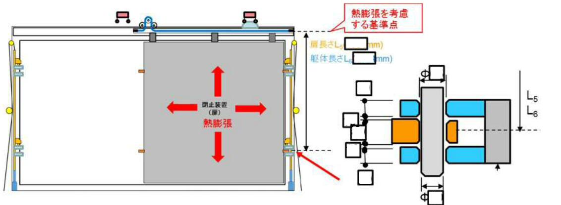
・SUS304の熱膨張係数 $\alpha_1: 1.6 \times 10^{-5}/^{\circ}\text{C}$ , 鉄筋コンクリートの熱膨張係数 $\alpha_2: 1.0 \times 10^{-5}/^{\circ}\text{C}$
