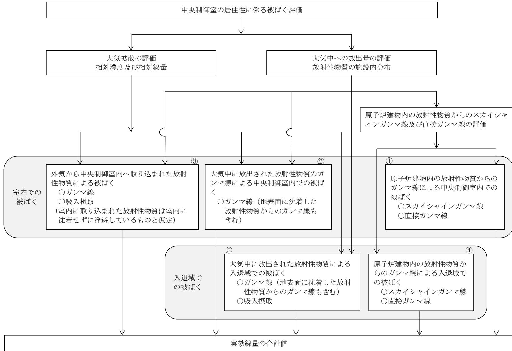
図2 中央制御室の運転員の被ばく経路
