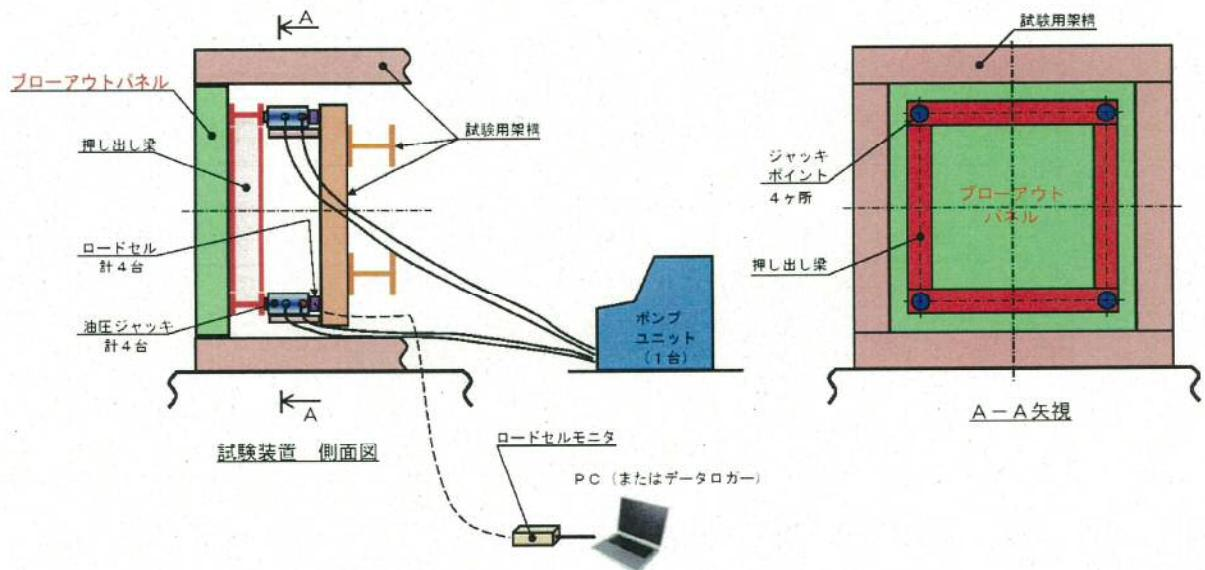
第6図 試験機器配置及び構成概念図
