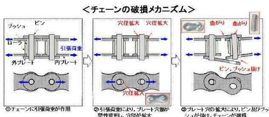
※図は扉閉状態のチェーン破損メカニズムであるが、扉開状態のチェーン破損メカニズムも同様。但し、扉が開状態であるためチェーン破損位置は扉を開ける側のチェーン端部近傍となる。
