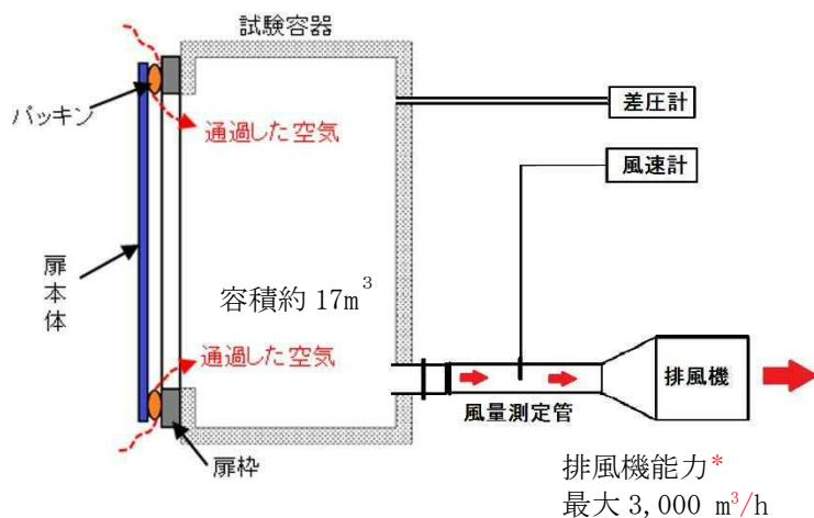
風量測定管径 :  $\phi 50\text{ mm}$
