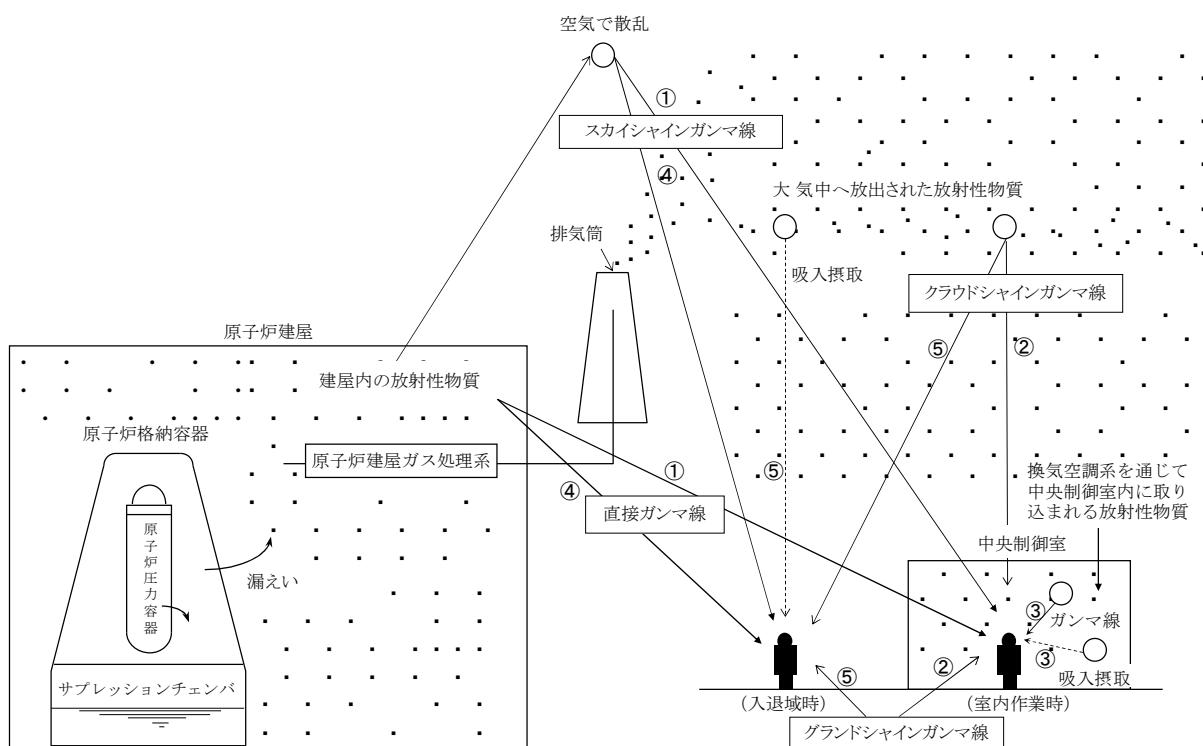
図3 中央制御室の居住性に係る被ばく経路イメージ
