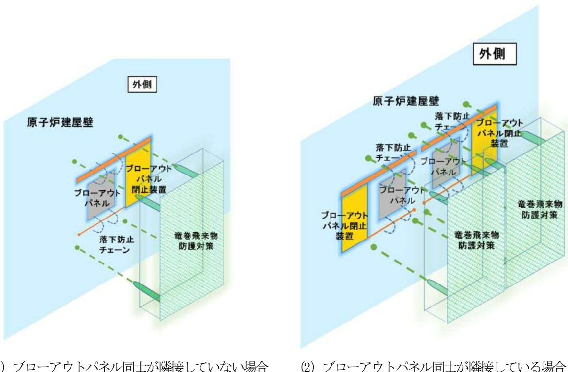
(1) プローアウトパネル同士が隣接していない場合 (2) プローアウトパネル同士が隣接している場合
