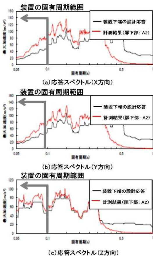
第3-1図 扉開 下部測定結果（試験 No. 5）
