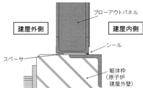
プローアウトパネル下部の詳細断面
