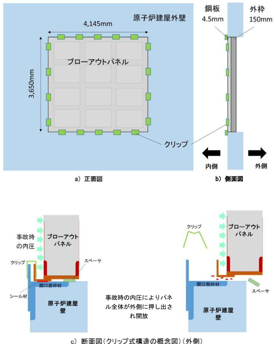
第 2-2 図 ブローアウトパネルの構造及び作動原理
