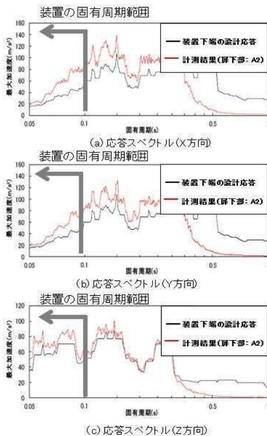
第3-5図 扇開 下部測定結果（試験 No. 7）
