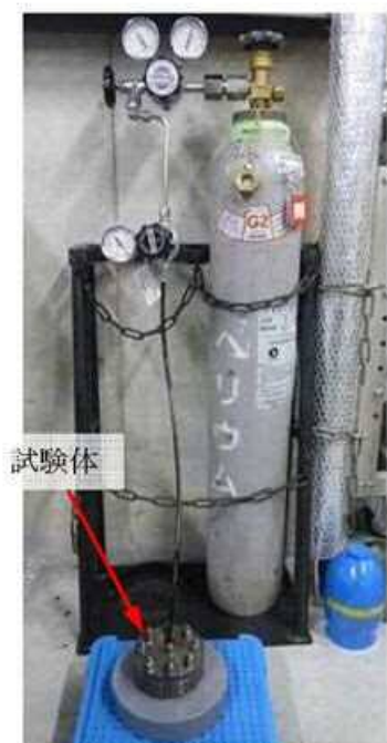
図5 He気密確認試験状況
