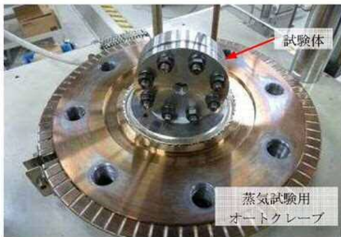
図4 蒸気曝露試験体設置状況
