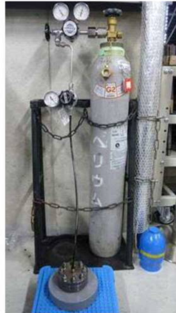
図 13 He 気密確認試験状況
