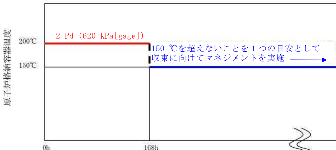
図6 格納容器温度の168時間以降の考え方
