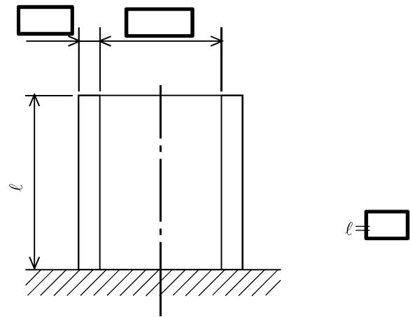
図 3-2 中央燃料支持金具の外荷重による応力計算モデル (単位 : mm)
