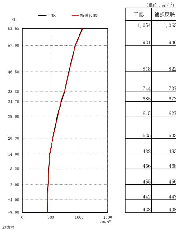
図 4-6 最大応答加速度 (S<sub>s</sub>-D 1, EW 方向)
