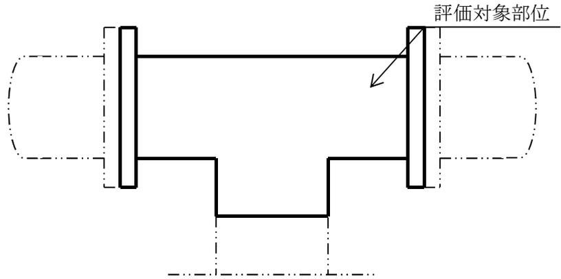
図 3-1 原子炉隔離時冷却系ストレーナ部ティーの形状
