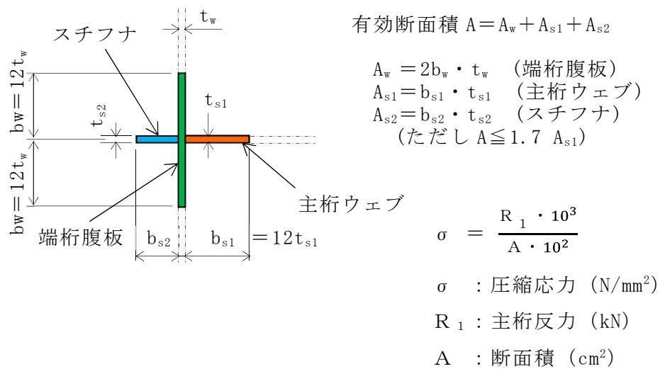
図 5-4 端桁のモデル図及び応力算定式
