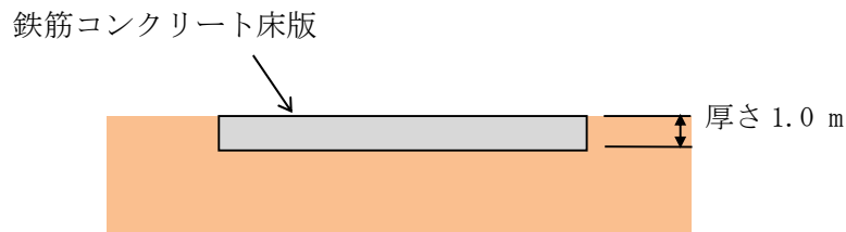
第 3-1 図 鉄筋コンクリート床版の概要
