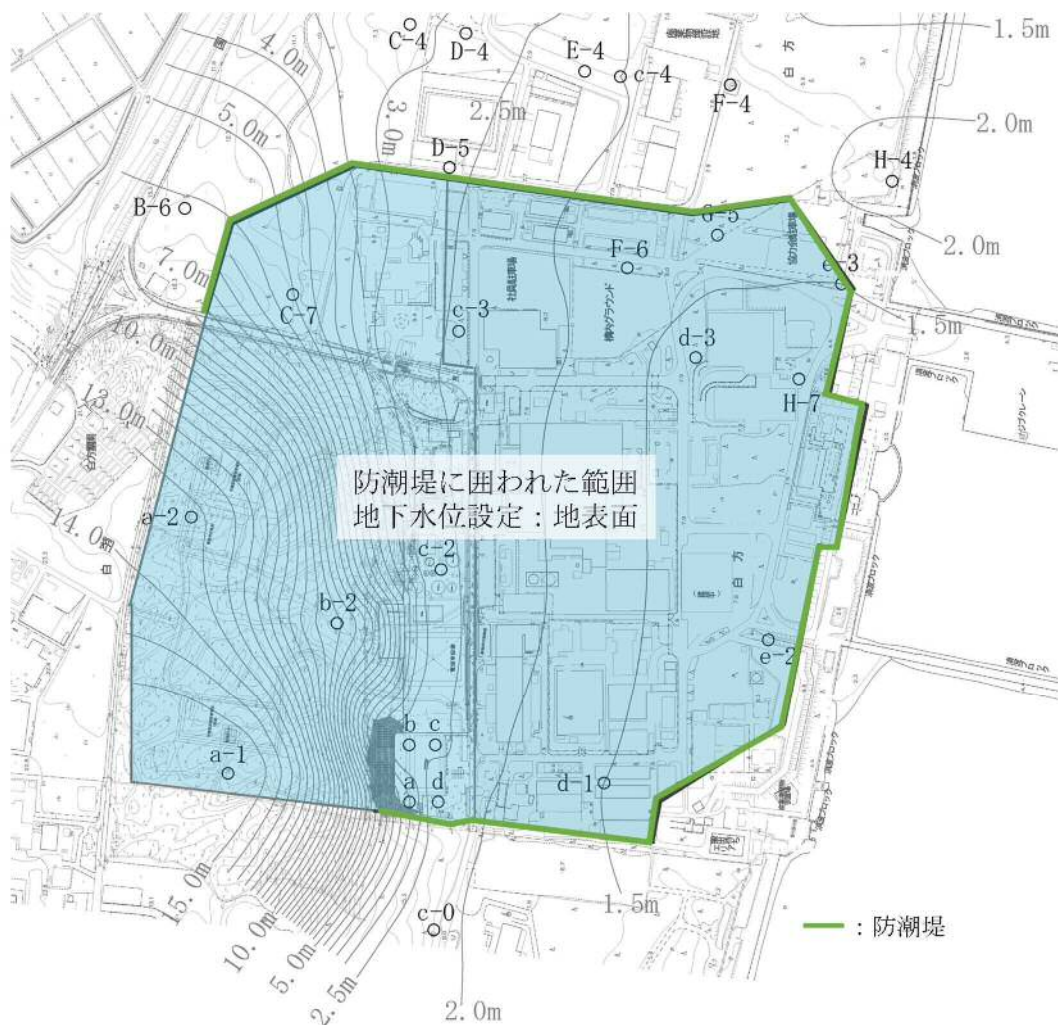
第 10-3 図 地下水位の設定図
