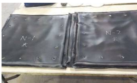
シートジョイントの全景（試験前）
