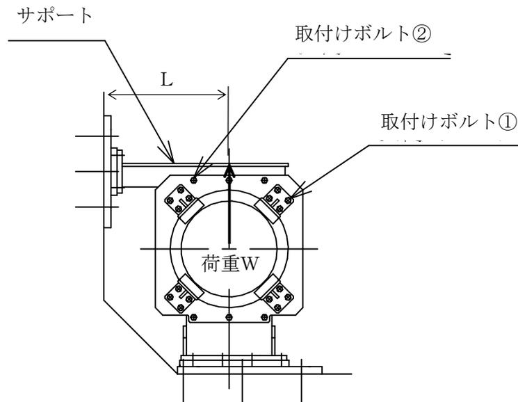
図 4-3 サポート部の応力計算モデル例
