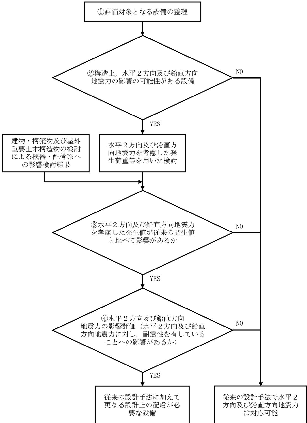
図 2-1 水平 2 方向及び鉛直方向地震力による影響評価フロー
