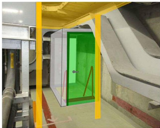
第14-2図 ケーブル処理室内階段室の設置イメージ
