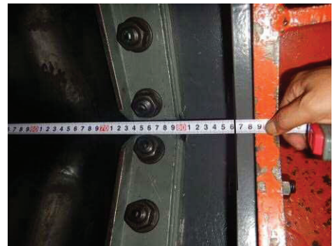
図 5. 13. 1－20 試験 No. ④ 枠間距離計測（底版：南側）
