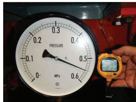
図 5.13.1-40 試験 No. ⑥ 加圧完了 (0.55MPa, 1 時間保持)
