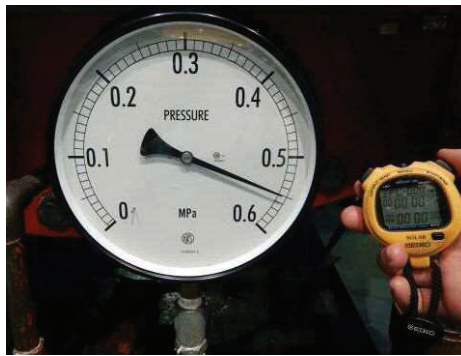
図 5.13.1-39 試験 No. ⑥ 加圧状況 (0.55MPa)
