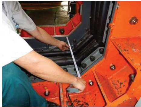
枠間距離計測状況
