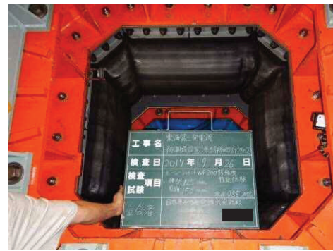
図 5.13.1-39 試験 No. ⑥ 加圧状況 (0.55MPa)
