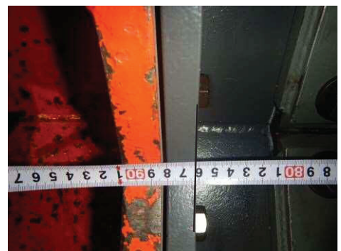
図 5. 13. 1－21 試験 No. ④ 枠間距離計測（底版：北側）
