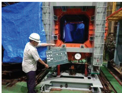
図 5.13.1-40 試験 No. ⑥ 加圧完了 (0.55MPa, 1 時間保持)
