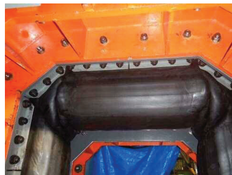
図 5.13.1-31 試験 No. ⑤ 加圧状況 (0.55 MPa)
