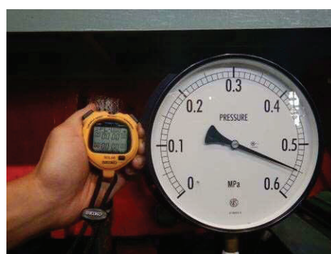
図 5.13.1-23 試験 No. ④ 加圧状況（0.55 MPa 加圧開始）
