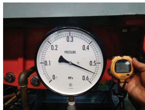
図 5.13.1-32 試験 No. ⑤ 加圧完了 (0.55 MPa, 1 時間保持)
