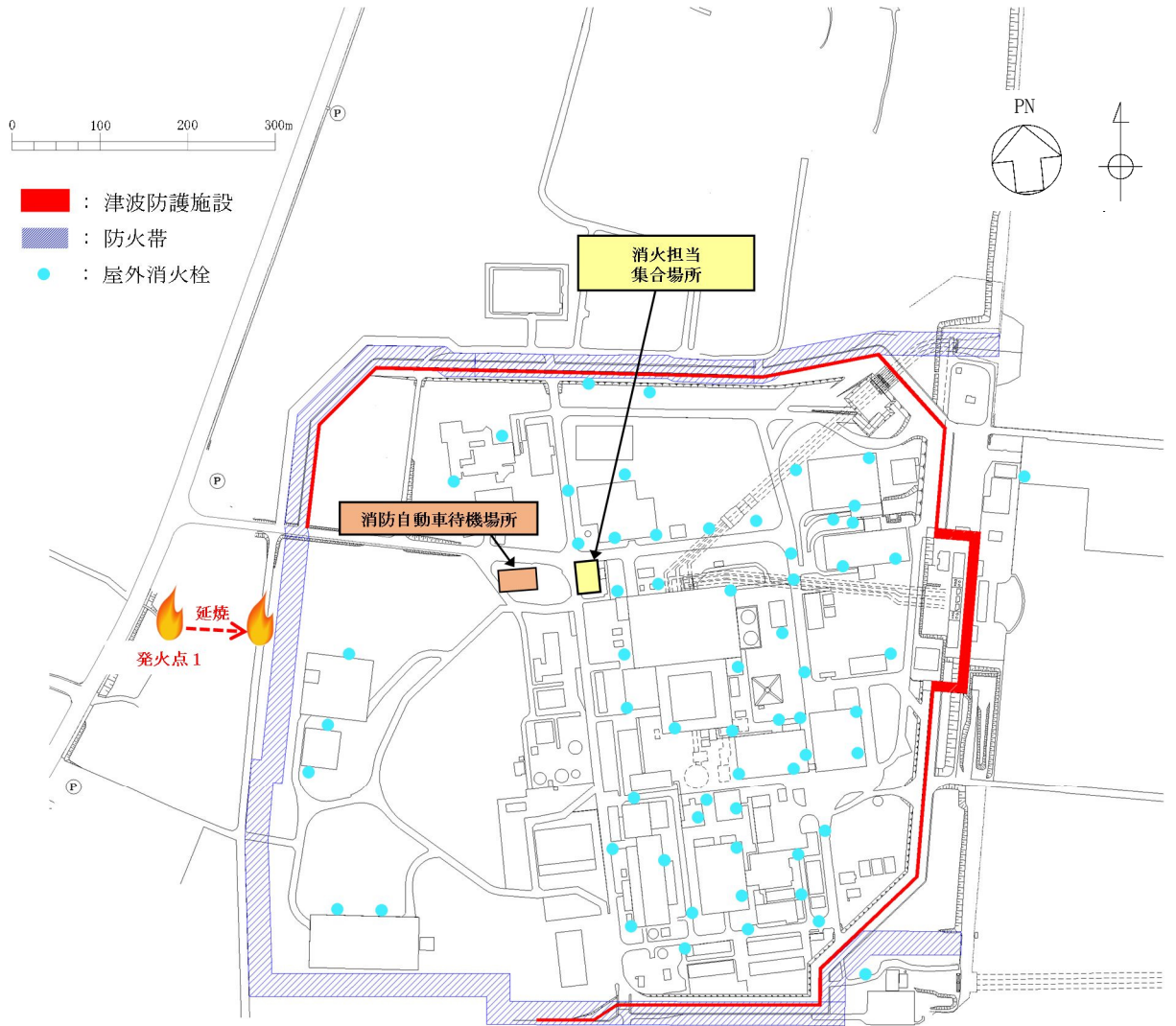
図 2. 1. 2-3 屋外消火栓の設置位置
