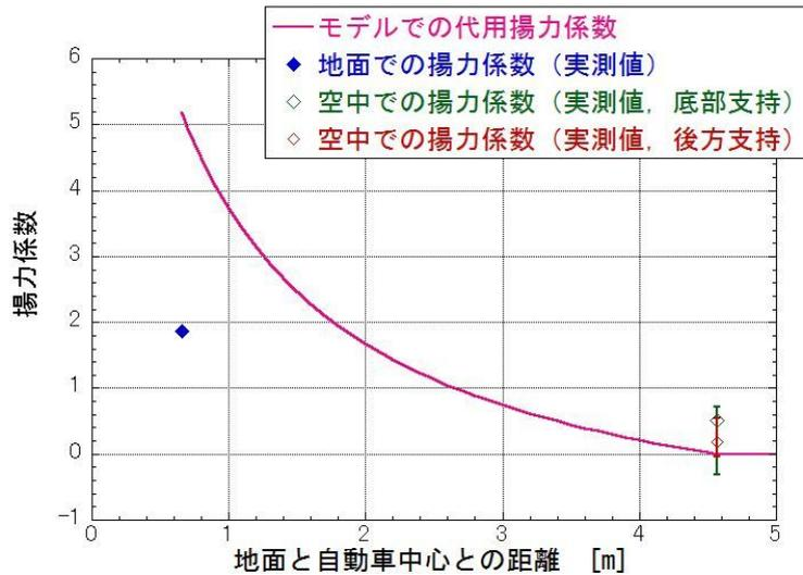
図 5-6 自動車の風洞実験による揚力係数と代用揚力係数
