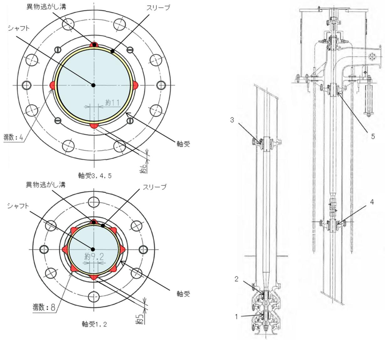
図 1-4 非常用ディーゼル発電機（高圧炉心スプレィ系ディーゼル発電機を含む。）用海水ポンプ
