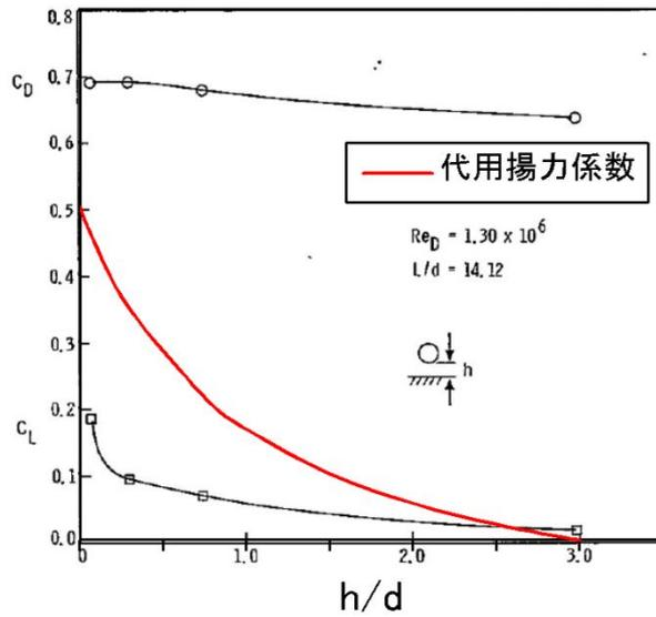
図 5-8 円柱の風洞試験による揚力係数と代用揚力係数
