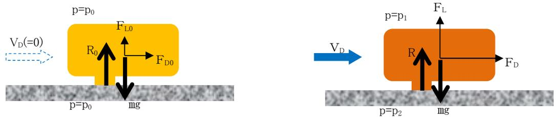
図 5-2 部分的に地面に接する物体に作用する力
