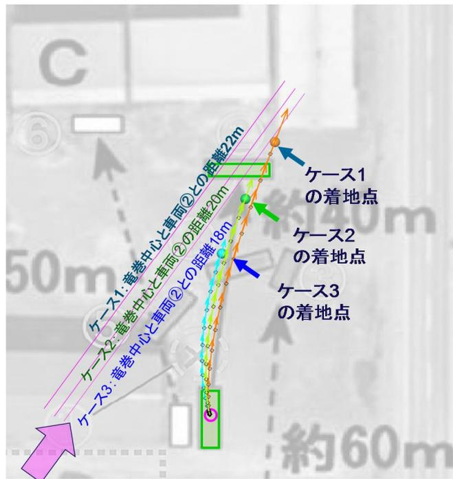
図 6-3 フジタモデルによる 4 t トラックの飛散解析結果
