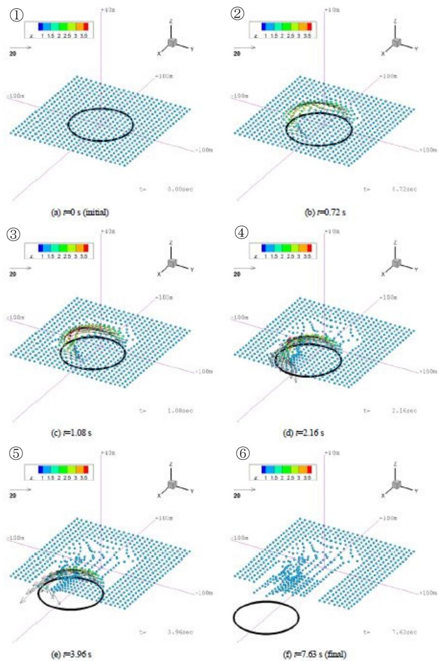
図 5-15 竜巻によるトラックの飛散イメージ<sup>(23)</sup>
