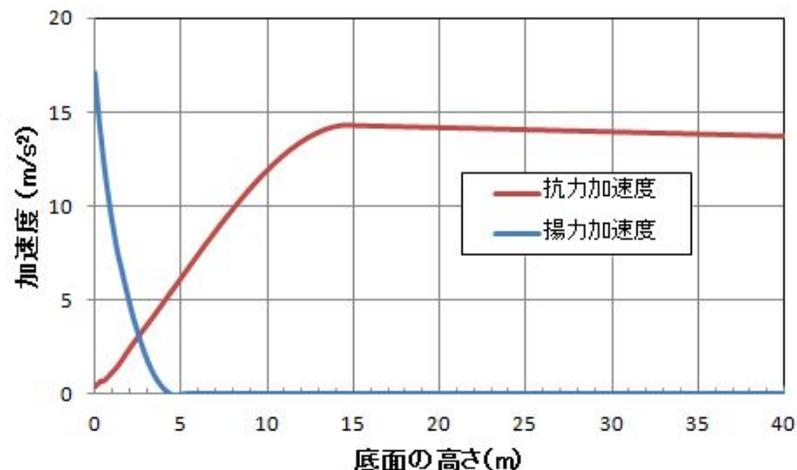
図 5-10 地面近傍の物体に作用する z 方向の加速度
