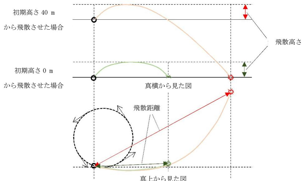
図 1-6 飛散評価における飛跡イメージ
