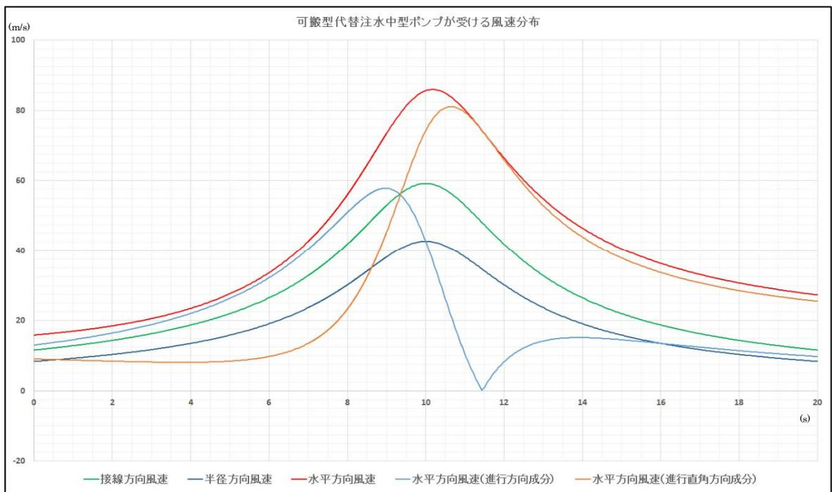
図 3-2 可搬型代替注水中型ポンプに作用する設計竜巻の風速の時刻歴分布
