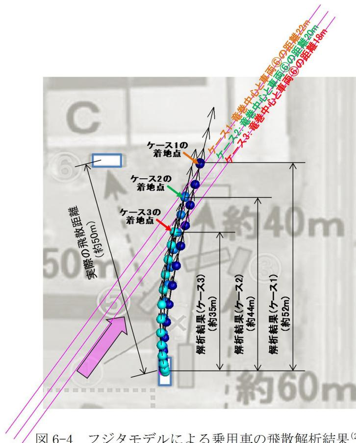
図 6-4 フジタモデルによる乗用車の飛散解析結果<sup>(23)</sup>
