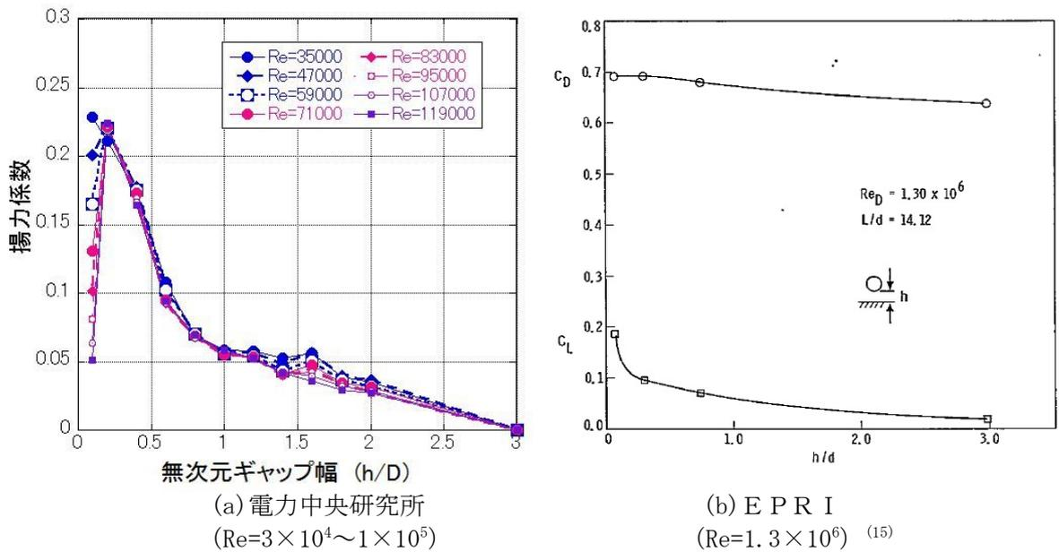
図 5-5 風洞実験による円柱の揚力係数
