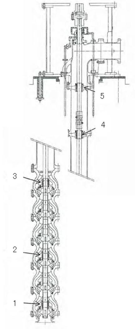
図 1-3 残留熱除去系海水系ポンプ軸受部詳細
