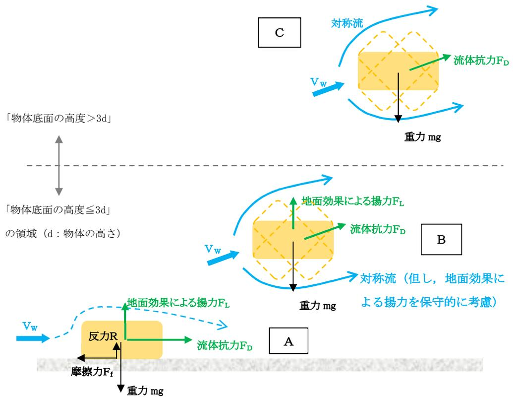
図 5-3 物体の運動モデルの模式図
