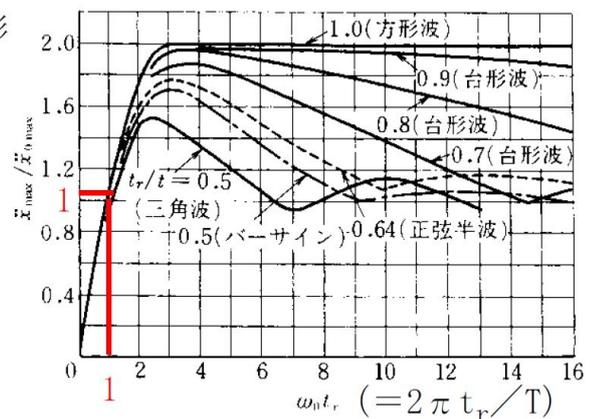
図 1-2 衝突時間と応答加速度の関係
