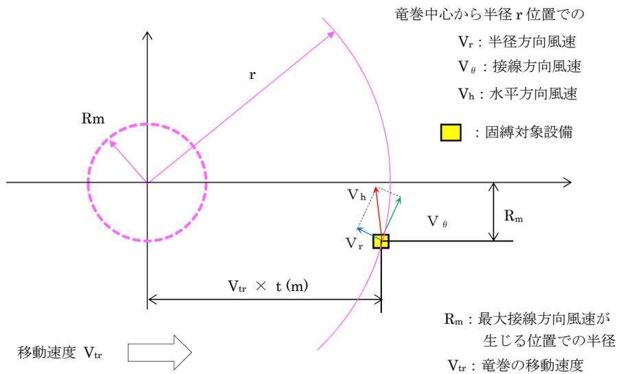
図3-1 固縛対象設備に作用する風速分布の検討モデル
