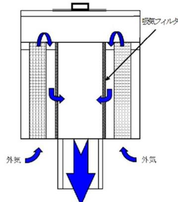
図 1-7 非常用ディーゼル発電機（高圧炉心スプレイ系ディーゼル発電機を含む。）吸気口
