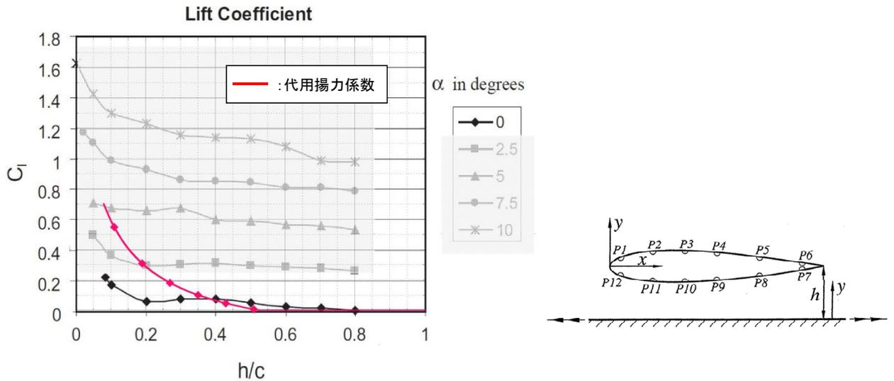
図 5-9 翼の風洞試験による揚力係数と平板の代用揚力係数
