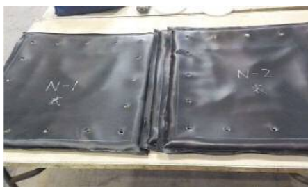
シートジョイントの全景（試験前）
