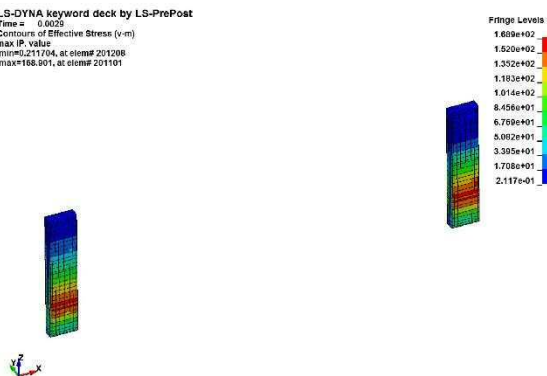
図 16 止水機構の衝突解析結果（横断方向）
