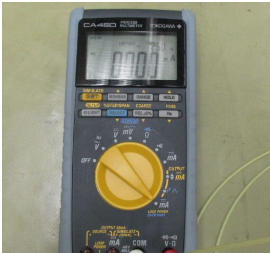
③ 可搬型計測器 (温度, 压力, 水位, 流量計測用)
