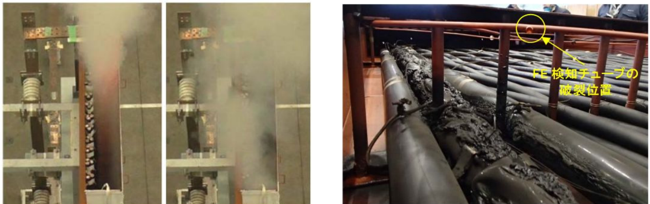
第 11 図 試験 V2 発火・消火・試験後の状態
