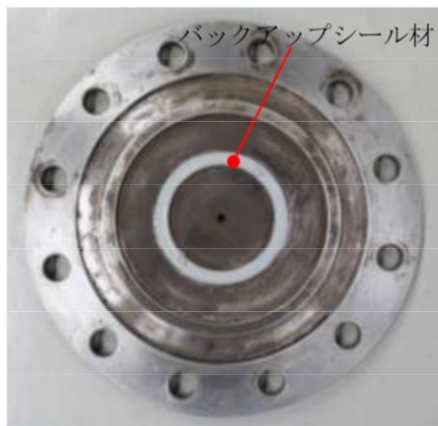
図7バックアップシール材塗布状況 (1.5mm 厚さ)
