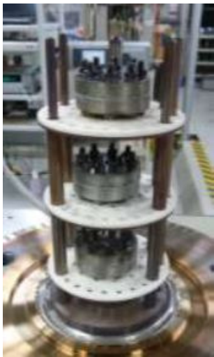
図4 蒸気曝露 試験片設置状況
