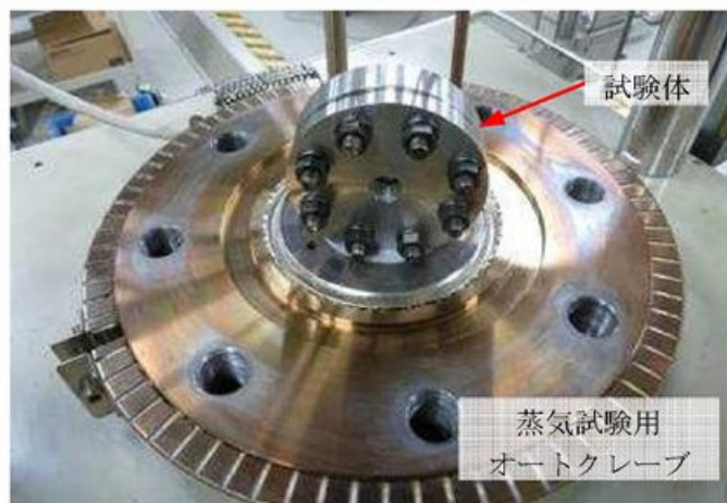
図4 蒸気曝露試験体設置状況
