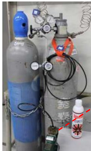
図5 気密確認試験状況
