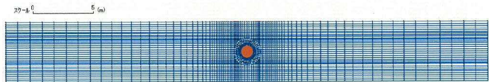
図 3 水平断面モデル (杭間隔 5D)
