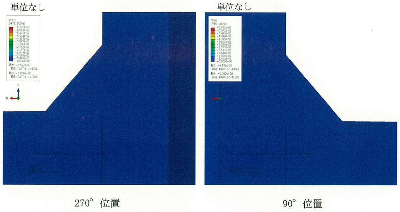
図3-20 崩壊荷重の下限 (Pcr) での応力・ひずみ分布図 (中心位置) (3/5)
