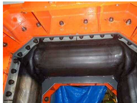
図 5.13.1-31 試験 No. ⑤ 加圧状況 (0.55 MPa)
