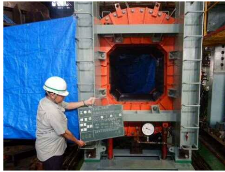
図 5. 13. 1-25 試験 No. ④ 全体状況 (0.55 MPa, 1 時間保持後)
