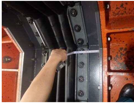
枠-ボルト間距離計測状況
