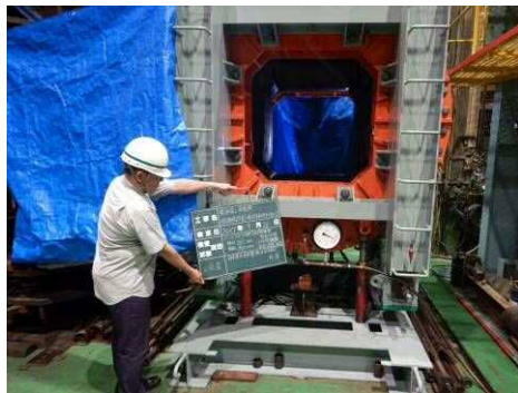
図 5.13.1-40 試験 No.⑥ 加圧完了 (0.55MPa, 1 時間保持)
