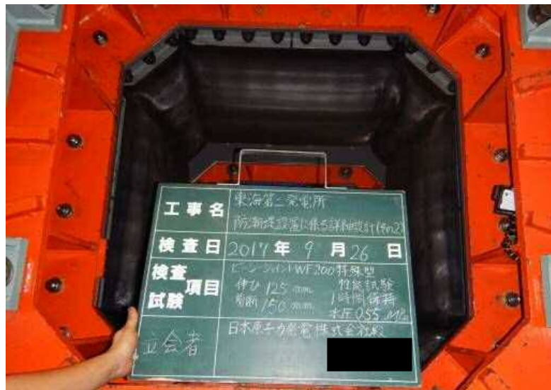
頂版 (漏えいなし)
