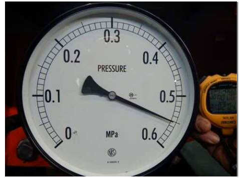
図 5. 13. 1-25 試験 No. ④ 全体状況 (0.55 MPa, 1 時間保持後)
