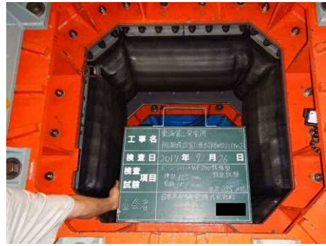
図 5.13.1-39 試験 No.⑥ 加圧状況 (0.55MPa)
