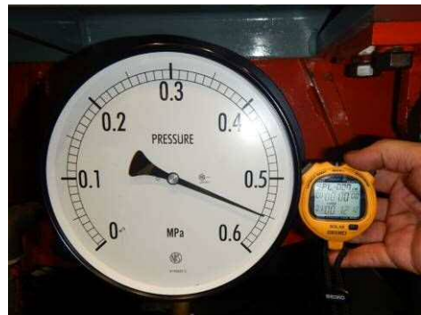
図 5.13.1-40 試験 No.⑥ 加圧完了 (0.55MPa, 1 時間保持)
