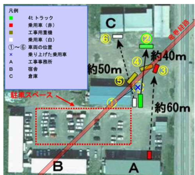
図 6-2 佐呂間竜巻による被災状況（工事事務所敷地内の車両被災）
