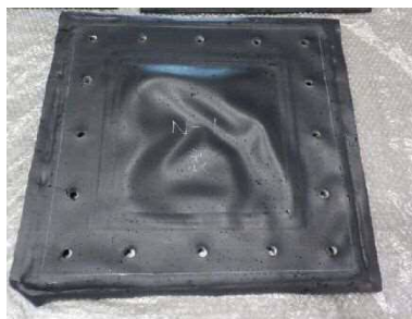
シートジョイントの全景 (試験後)
