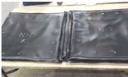
シートジョイントの全景 (試験前)
