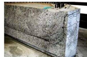
破壊面 (基準供試体)
