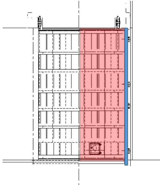
図17 支圧板にかかる荷重範囲図
