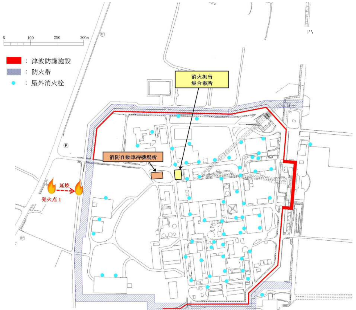
図 2. 1. 2-3 屋外消火栓の設置位置
