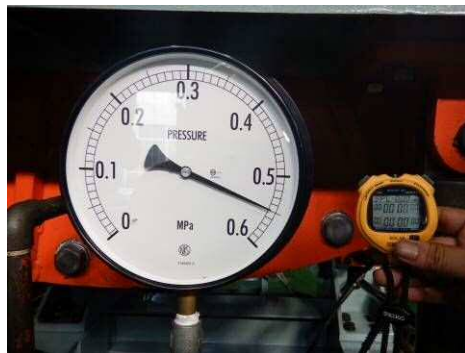
図 5.13.1-31 試験 No. ⑤ 加圧状況 (0.55 MPa)
