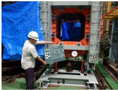
図 5.13.1-40 試験 No.⑥ 加圧完了 (0.55MPa, 1 時間保持)
