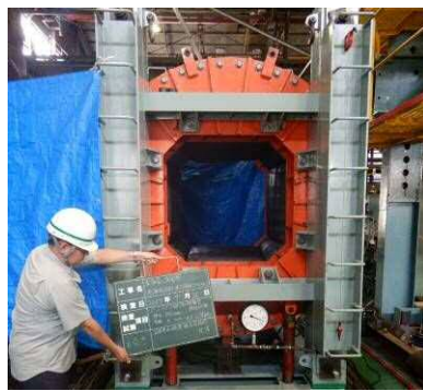
図 5.13.1-23 試験 No. ④ 加圧状況 (0.55 MPa 加圧開始)
