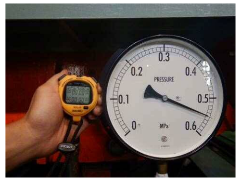
図 5.13.1-23 試験 No. ④ 加圧状況 (0.55 MPa 加圧開始)
