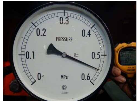
図 5.13.1-25 試験 No.④ 全体状況 (0.55 MPa, 1 時間保持後)
