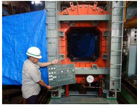
図 5.13.1-25 試験 No.④ 全体状況 (0.55 MPa, 1 時間保持後)
