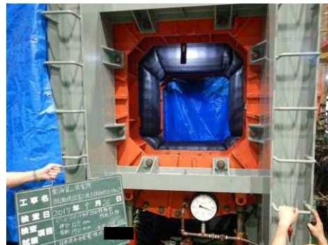
図 5.13.1-37 試験 No. ⑥ 全体状況 (0.55MPa 加压開始)
