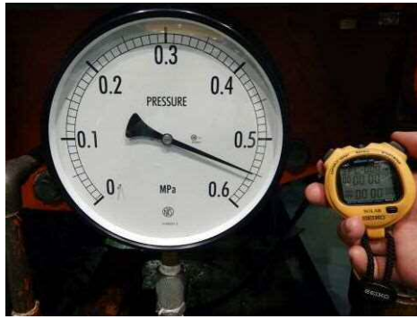
図 5.13.1-39 試験 No.⑥ 加圧状況 (0.55MPa)
