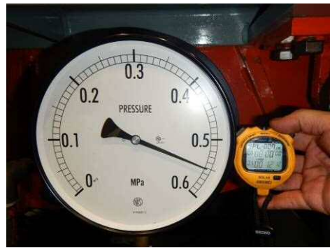
図 5.13.1-40 試験 No.⑥ 加圧完了 (0.55MPa, 1 時間保持)
