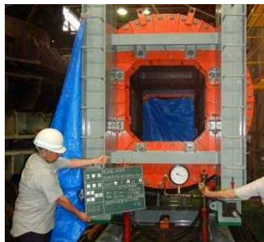
図 5.13.1-32 試験 No. ⑤ 加圧完了 (0.55 MPa, 1 時間保持)
