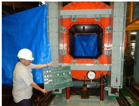
図 5.13.1-37 試験 No. ⑥ 全体状況 (0.55MPa 加压開始)
