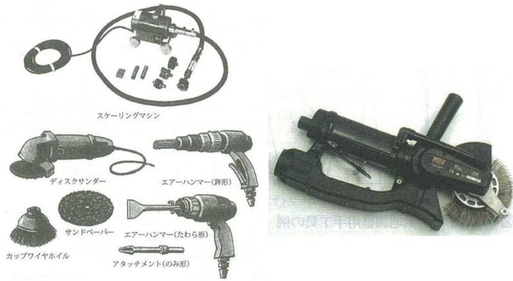
図 5.13.2.3-14 素地調整用動力工具の例
