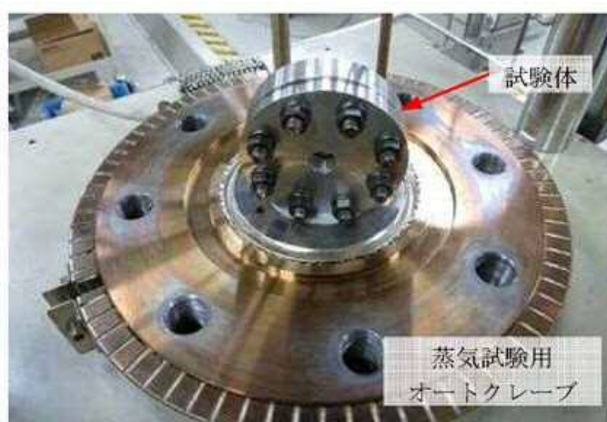
図4 蒸気曝露試験体設置状況
