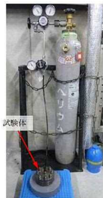
図5 He気密確認試験状況
