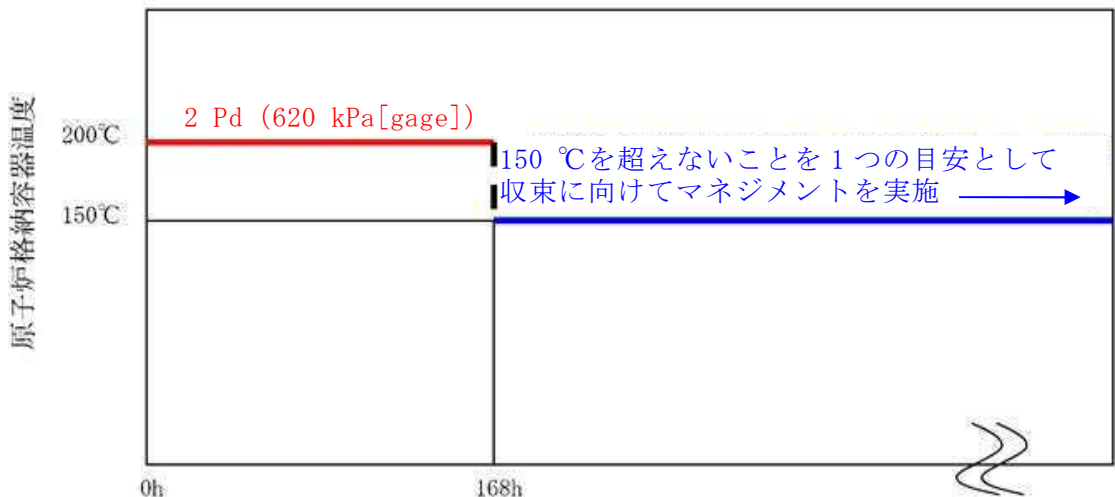
図 6 格納容器温度の 168 時間以降の考え方
