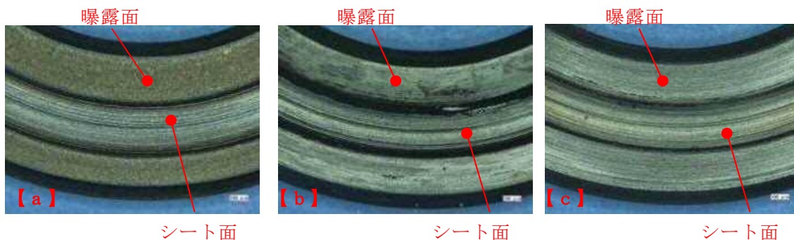
図7 試験後外観観察結果
