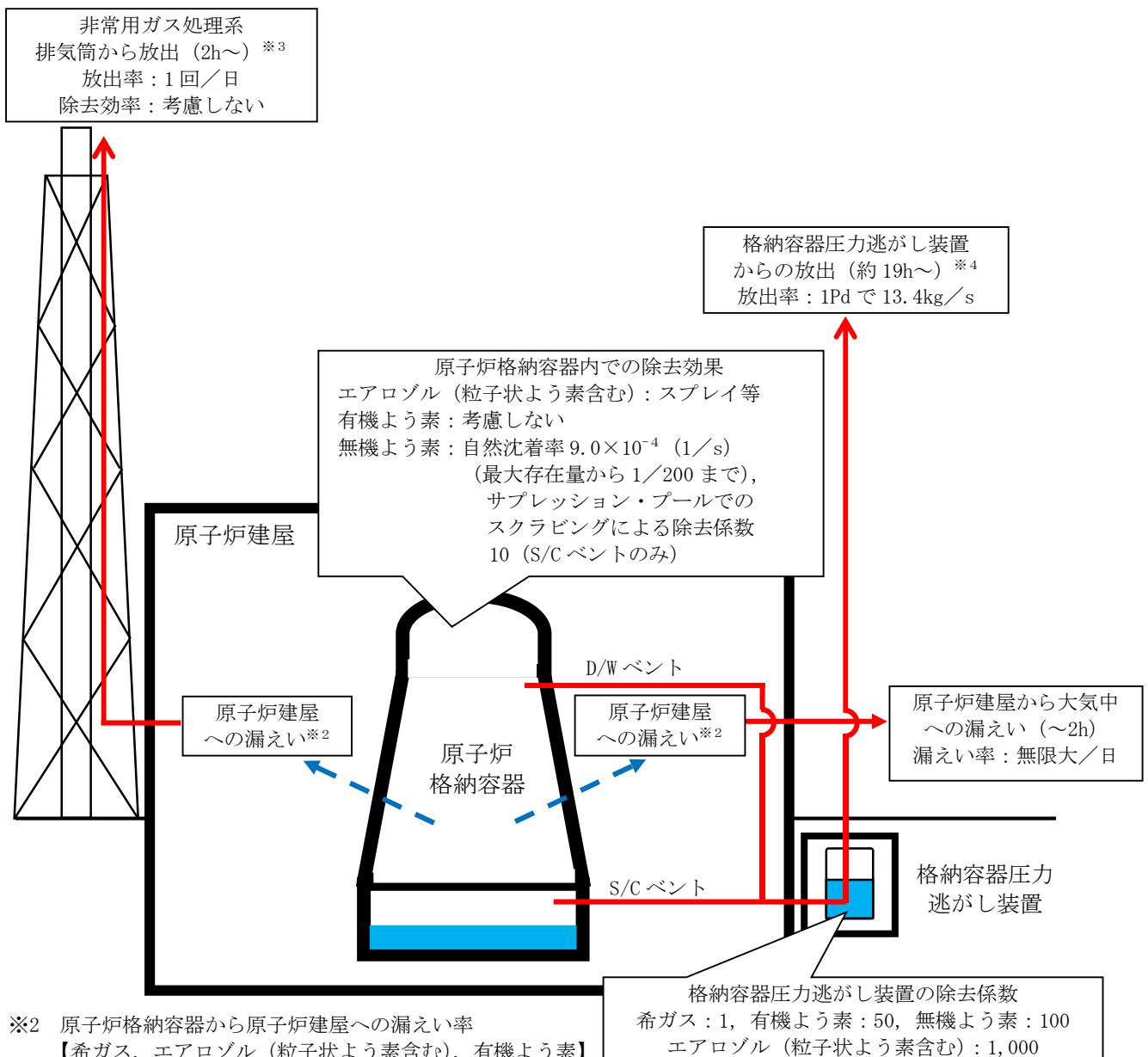
※2 原子炉格納容器から原子炉建屋への漏えい率
