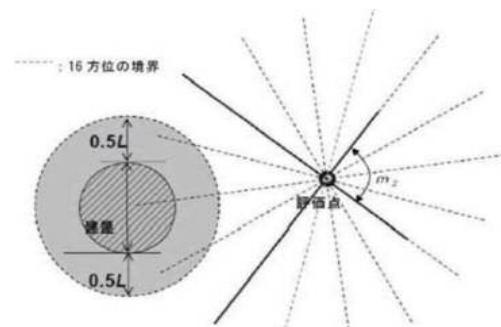
注:Lは、風向に垂直な建屋の投影面の高さ又は投影面の幅のうちの小さい方
