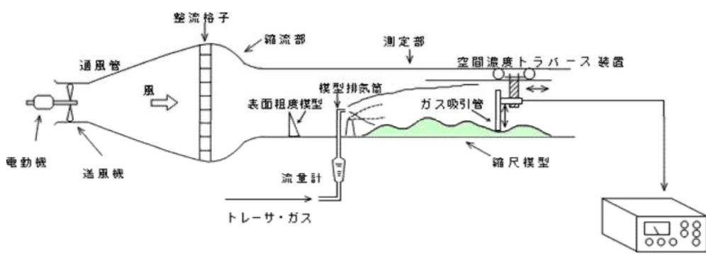
第1図 風洞実験装置
