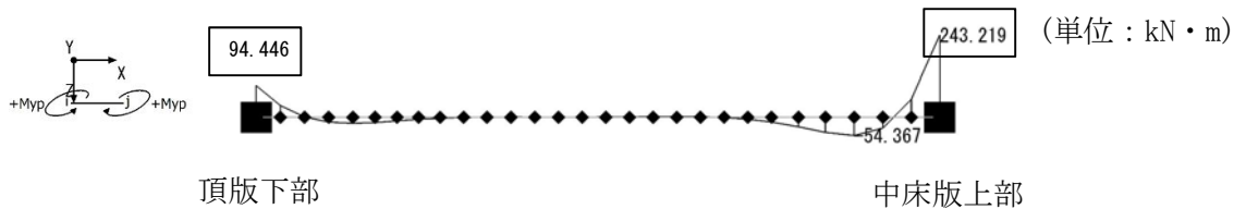
図 14.4-13 (3) 側壁両端固定梁モデルにおける曲げモーメント図 (②-②断面, 側壁上部 S_s-D1 [H+, V+]) (検討ケース④: 敷地に存在しない豊浦標準砂の液状化強度特性により 地盤を強制的に液状化させることを仮定した解析ケース)
