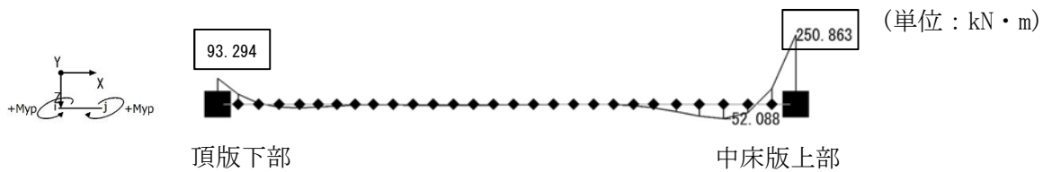
図 14.4-13 (1) 側壁両端固定梁モデルにおける曲げモーメント図 (①-①断面, 側壁上部 S_s-D1 [H+, V-]) (検討ケース①: 原地盤に基づく液状化強度特性を用いた解析ケース)
