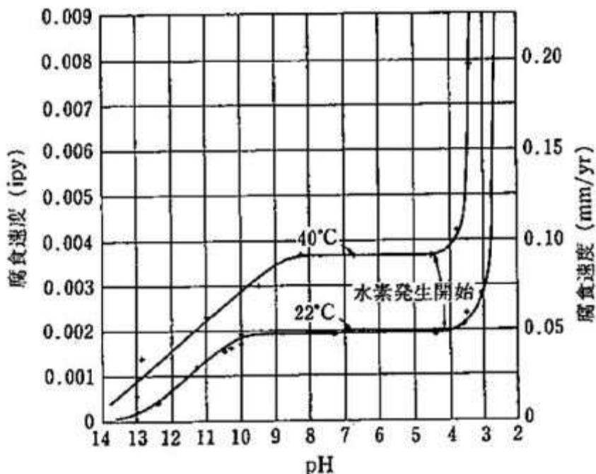
図3 炭素鋼の腐食に及ぼすpHの影響
