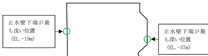
図2 止水壁のモデル化位置
