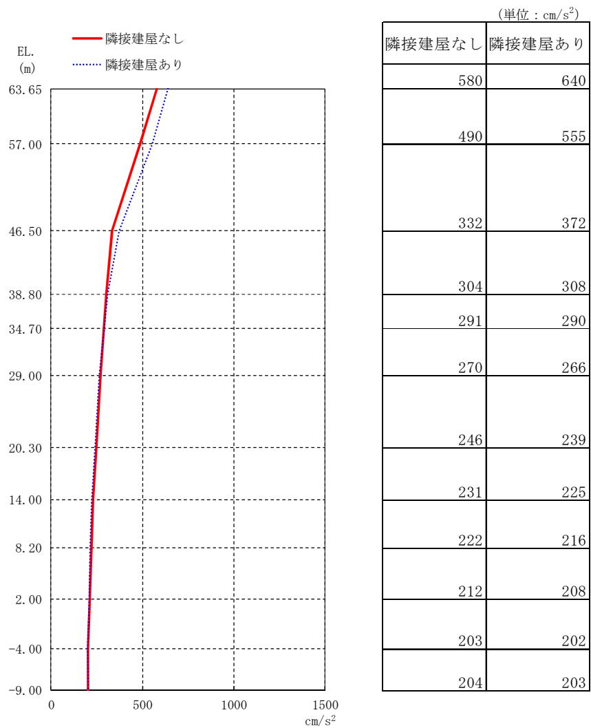
図 3-9 最大応答加速度 (原子炉建屋, S<sub>d</sub> - D 1, NS 方向)
