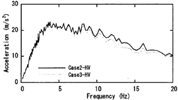
(b) 鉛直加速度応答スペクトル
