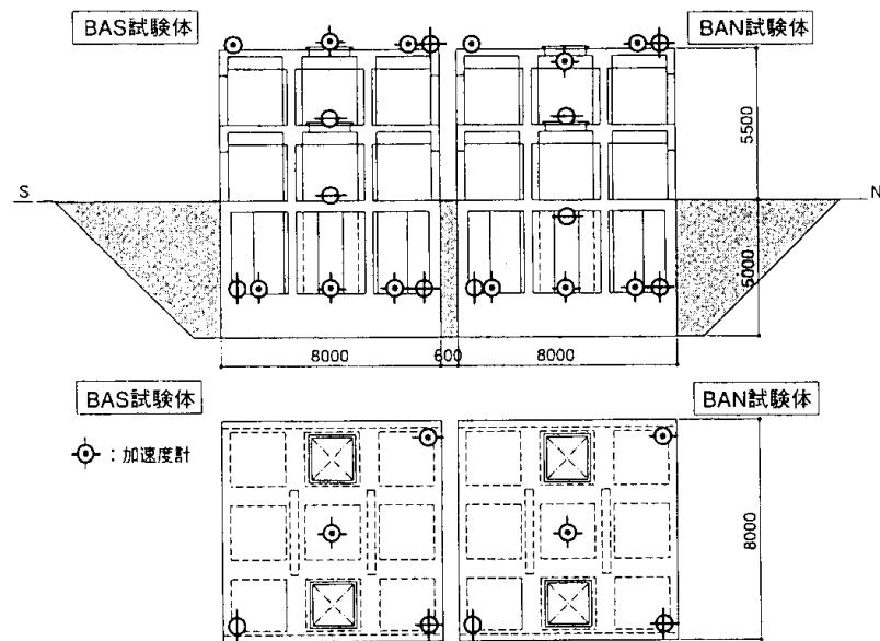
図 2-4 試験体内の加速度計配置図 (BAS, BAN 試験体)<sup>1)</sup>
