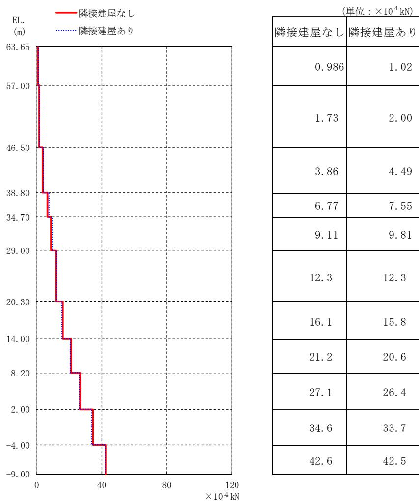
図 3-10 最大応答せん断力 (原子炉建屋, S\_d-D 1, NS 方向)
