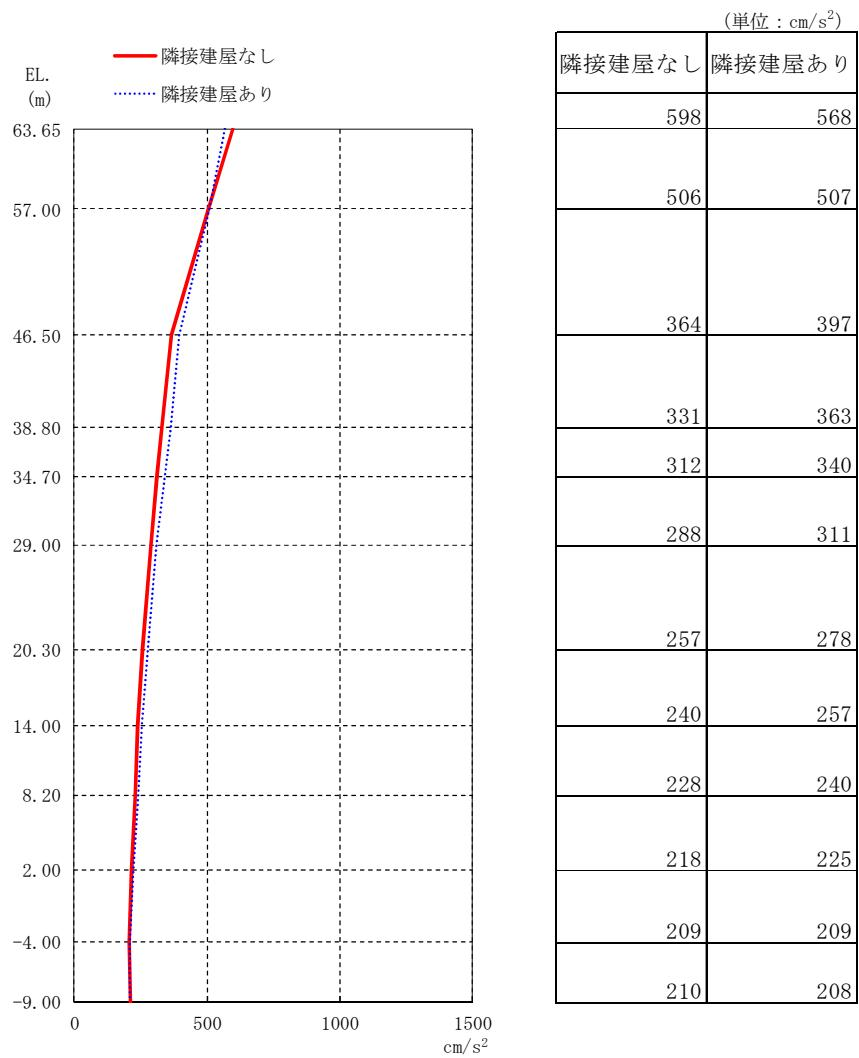
図 3-11 最大応答加速度 (原子炉建屋, S<sub>d</sub> - D 1, EW 方向)
