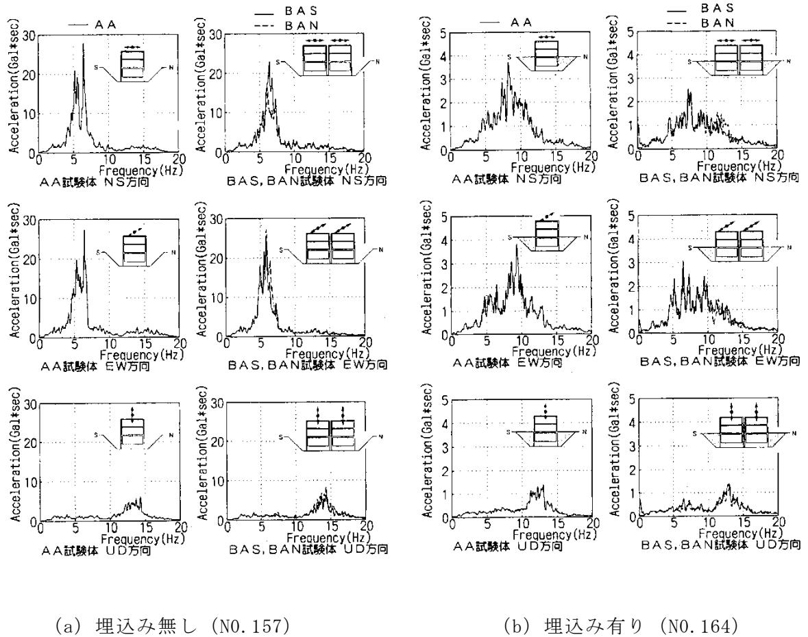
図 2-7 建屋観測結果の比較（単独と同種 2 棟隣接）<sup>2)</sup>
