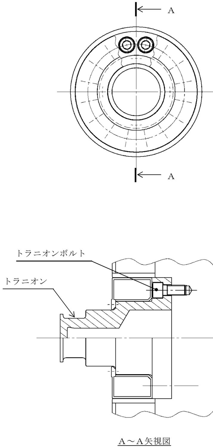
図 2-1 トラニオンの応力解析箇所
