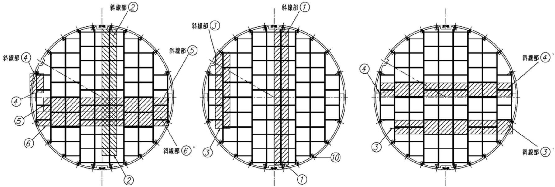
図 5-2(1) 枠板の応力評価で考慮する質量
