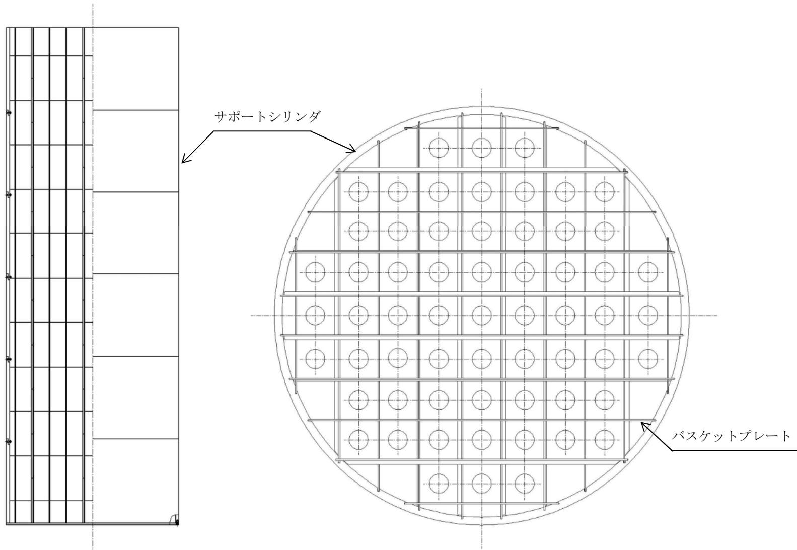
図 2-1 バスケットの応力解析箇所
