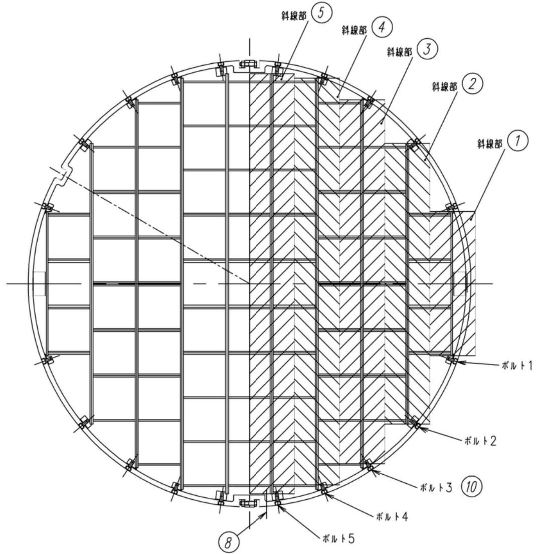
図 5-2(2) 拘束リングの応力評価で考慮する質量
