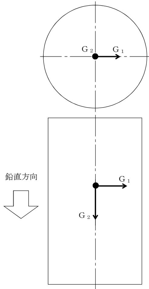
図 5-2 地震時におけるバスケットの姿勢と荷重方向
