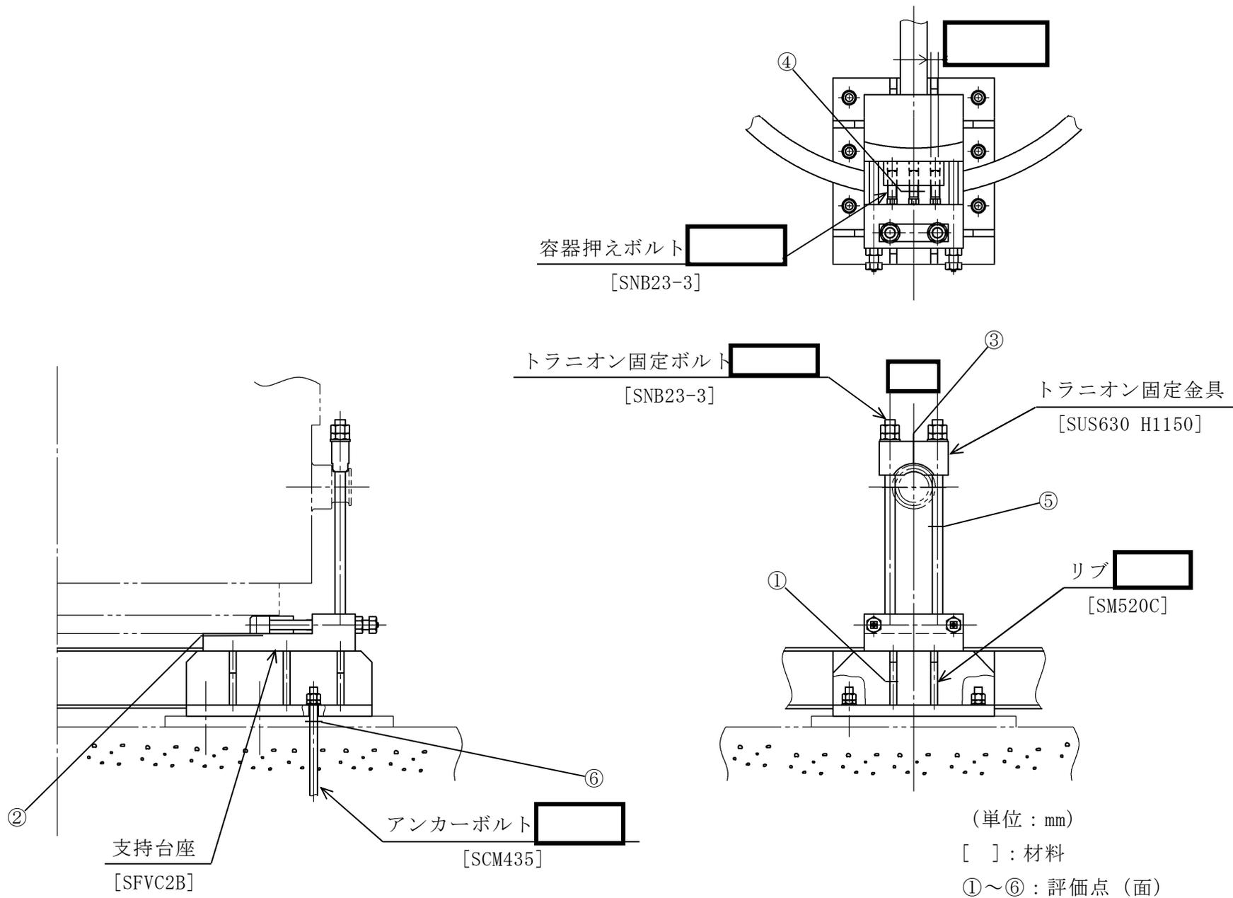
図 5-1 形状・寸法・材料・応力評価点(面)
