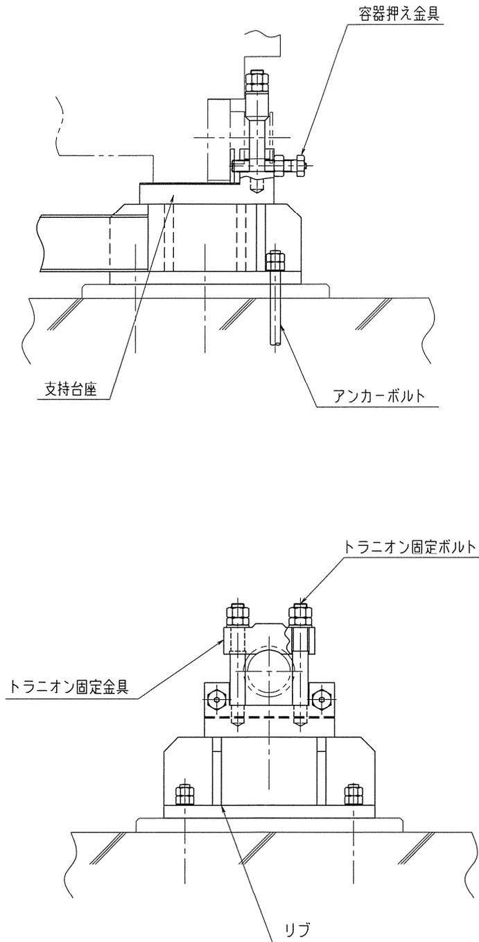
図 2-1 支持構造物の応力解析箇所
