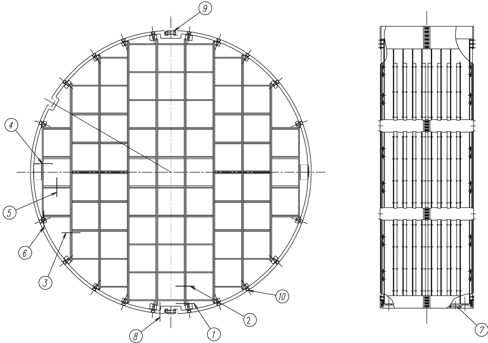
図 5-1 バスケットの応力評価点 (面)
