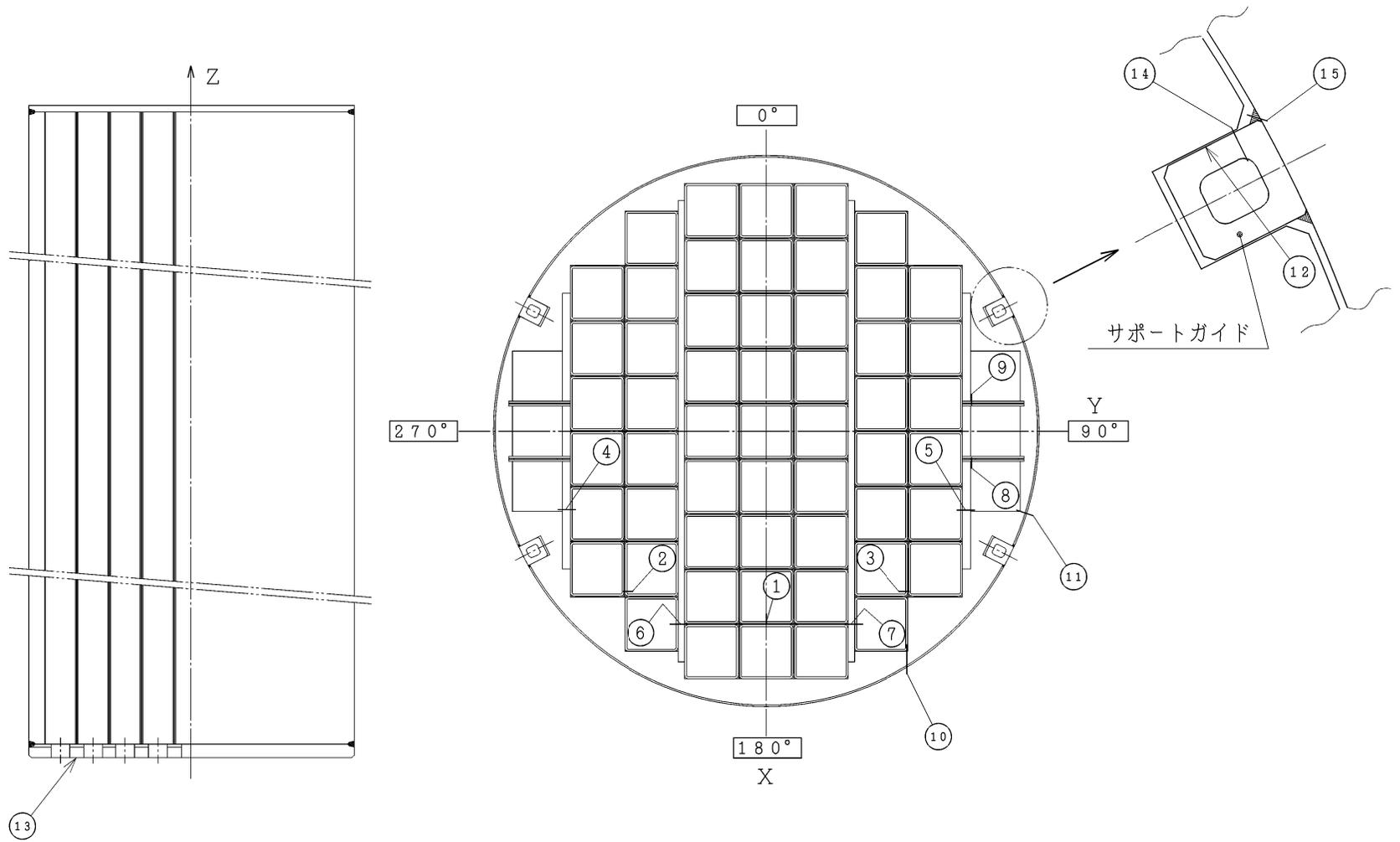
図 5-1 バスケットの応力評価点 (面)
