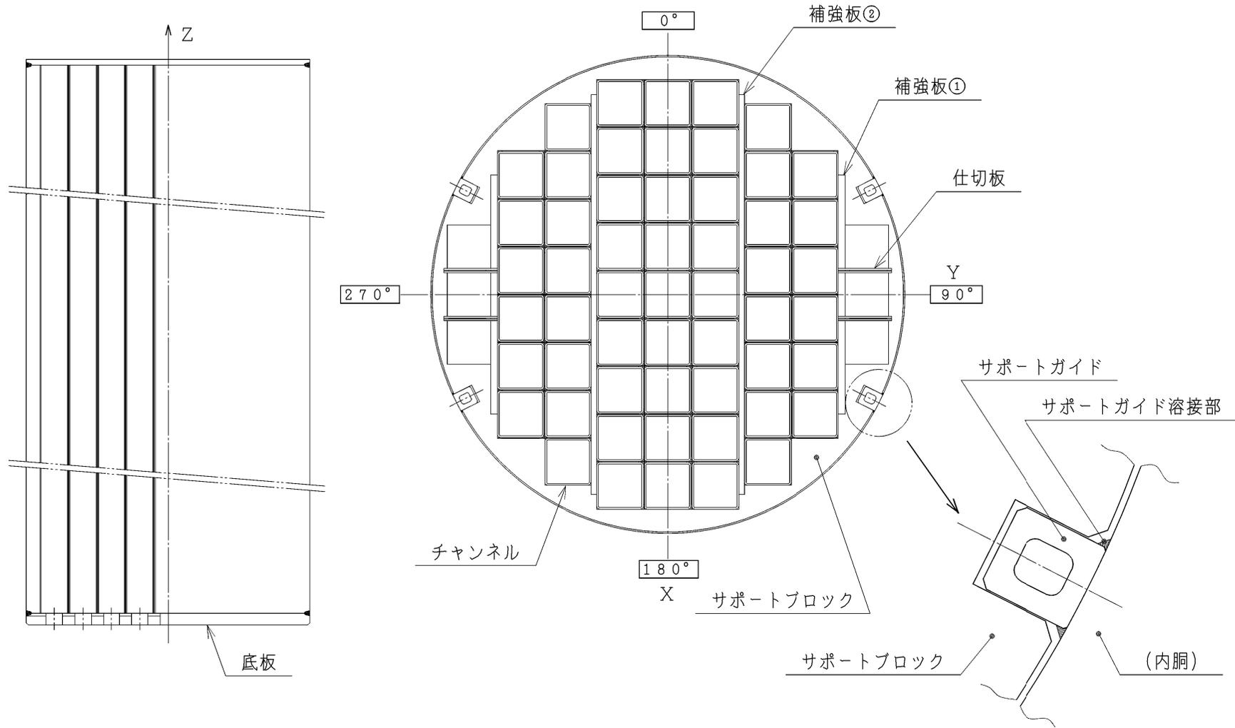
図 2-1 バスケットの応力解析箇所
