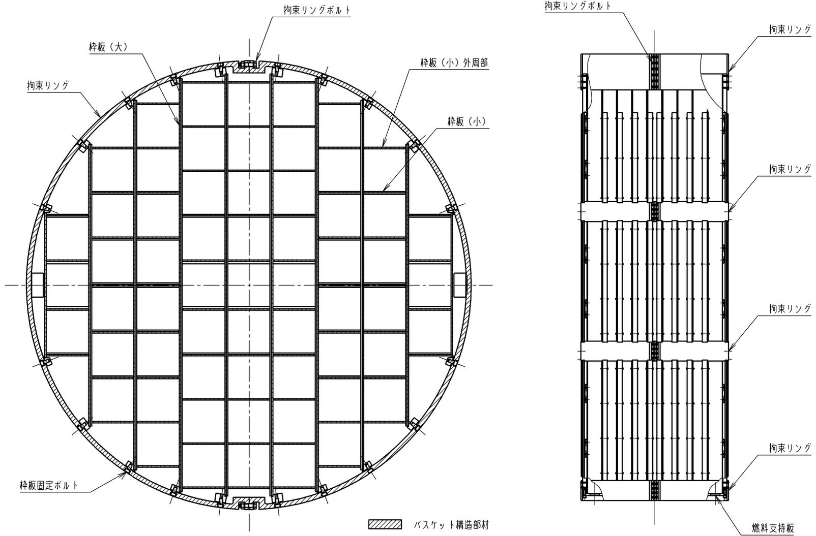
図 2-1 バスケットの応力解析箇所
