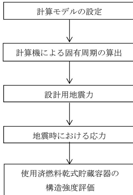
図 2-1 使用済燃料乾式貯蔵容器の耐震評価フロー
