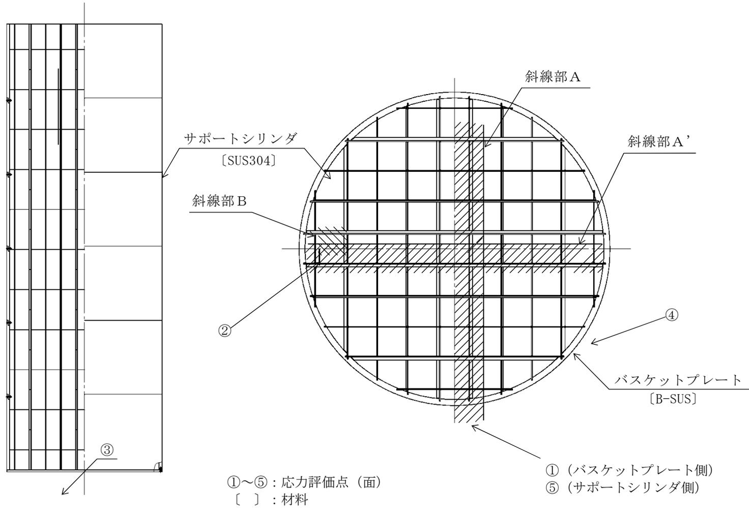
図 5-1 バスケットの応力評価点 (面)
