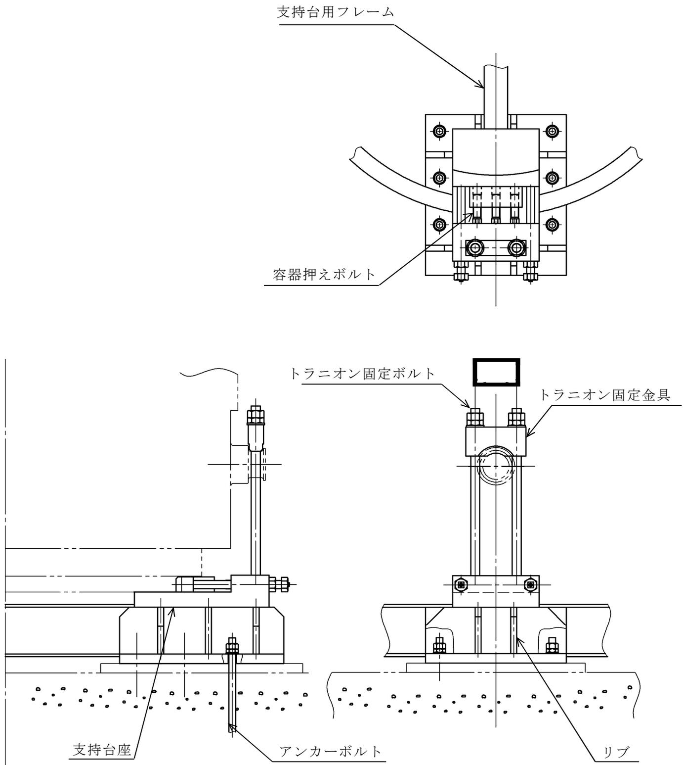
図 2-1 支持構造物の応力解析箇所
