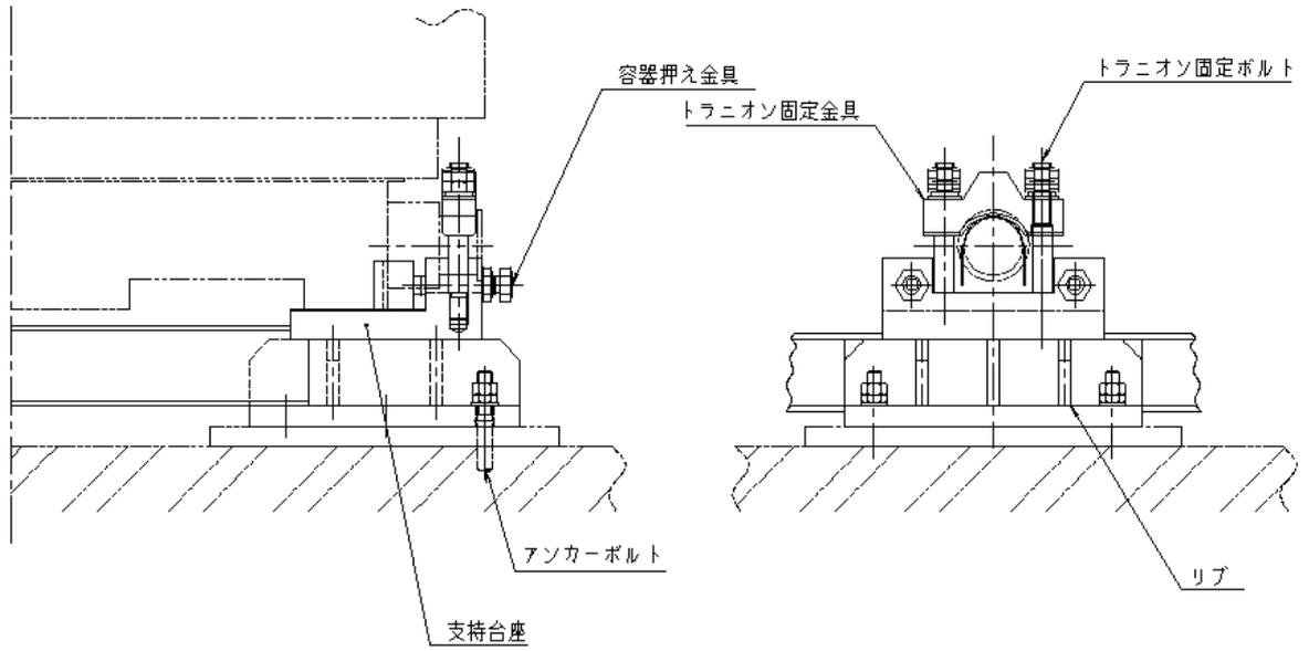
図 2-1 支持構造物の応力解析箇所
