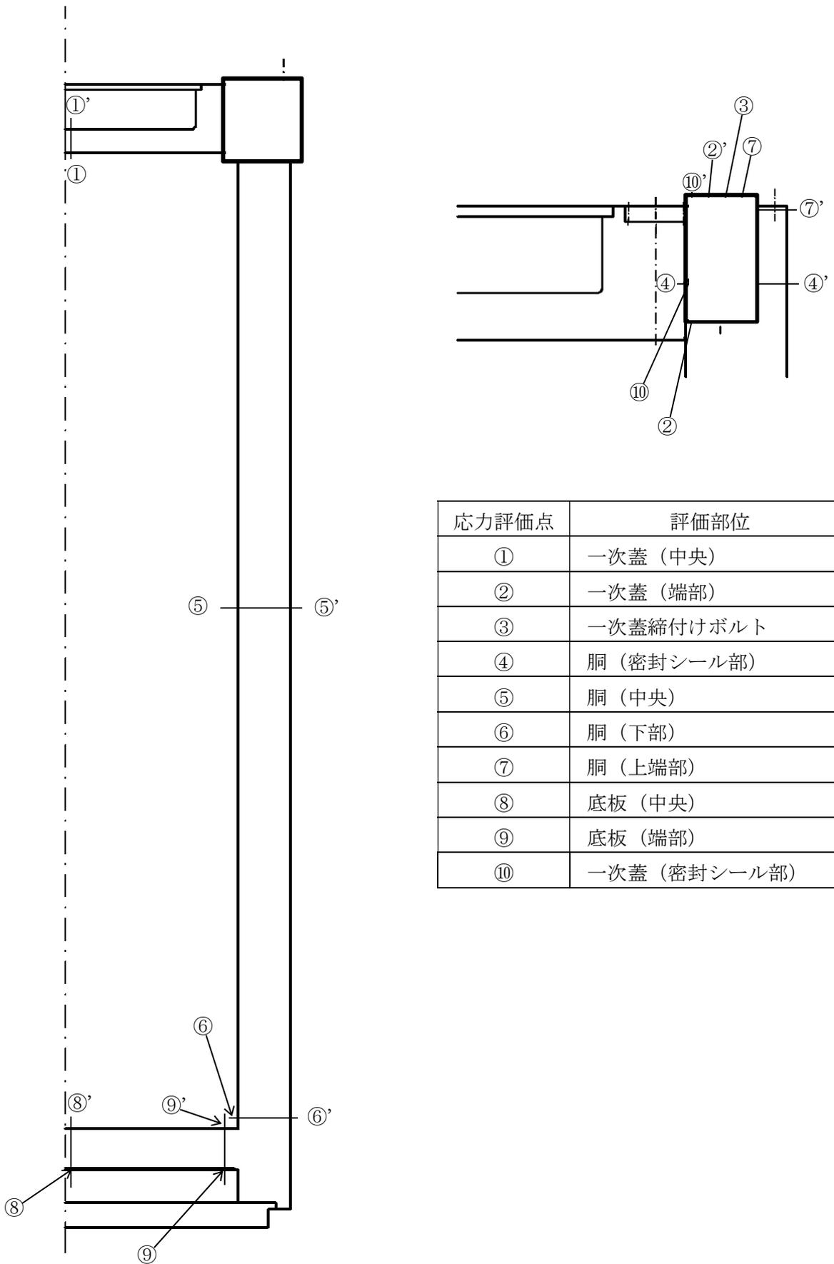
図 5-1 キヤスク容器の応力評価点（面）
