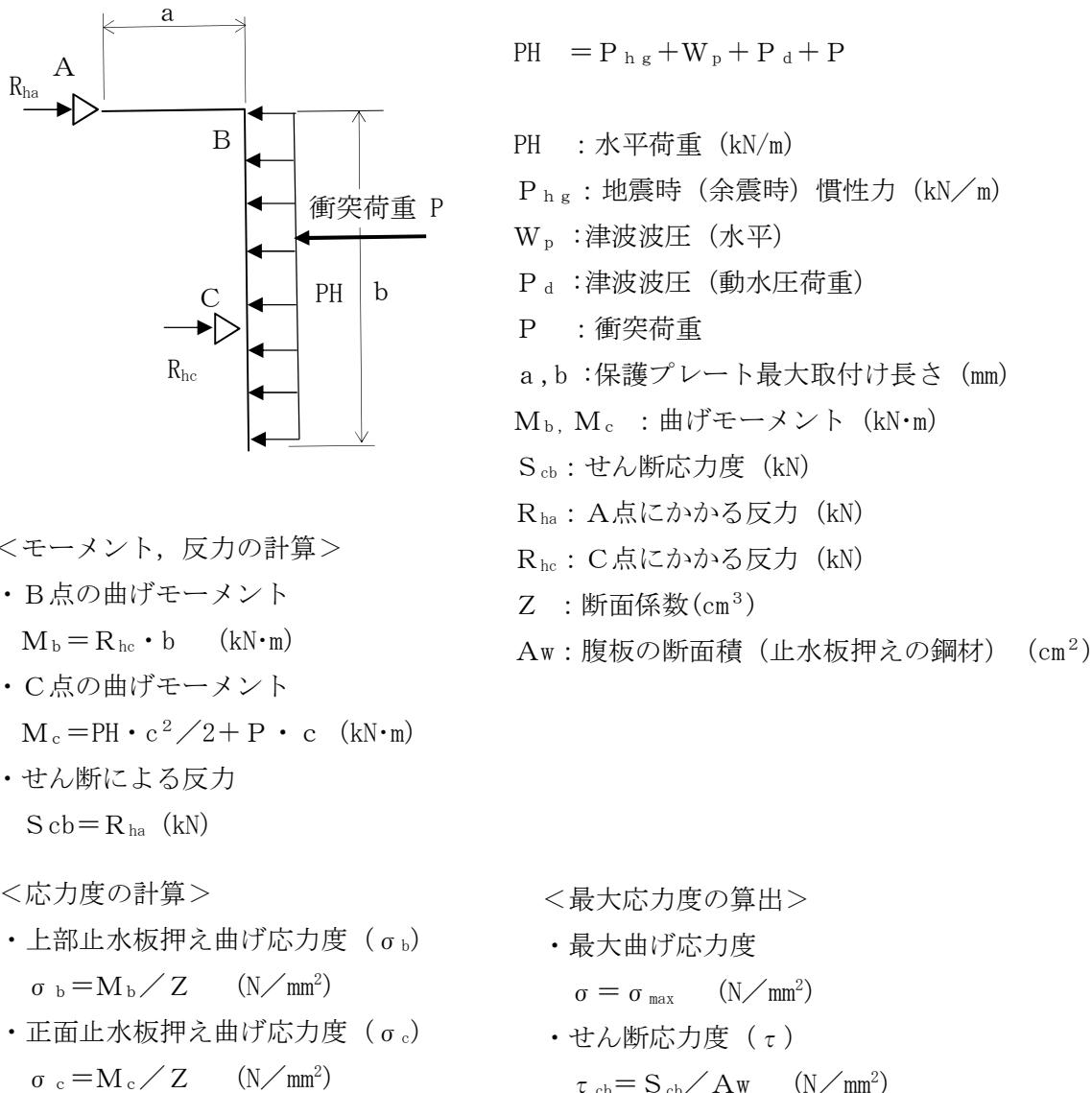
図 5-4 止水板押えのモデル図及び応力計算式
