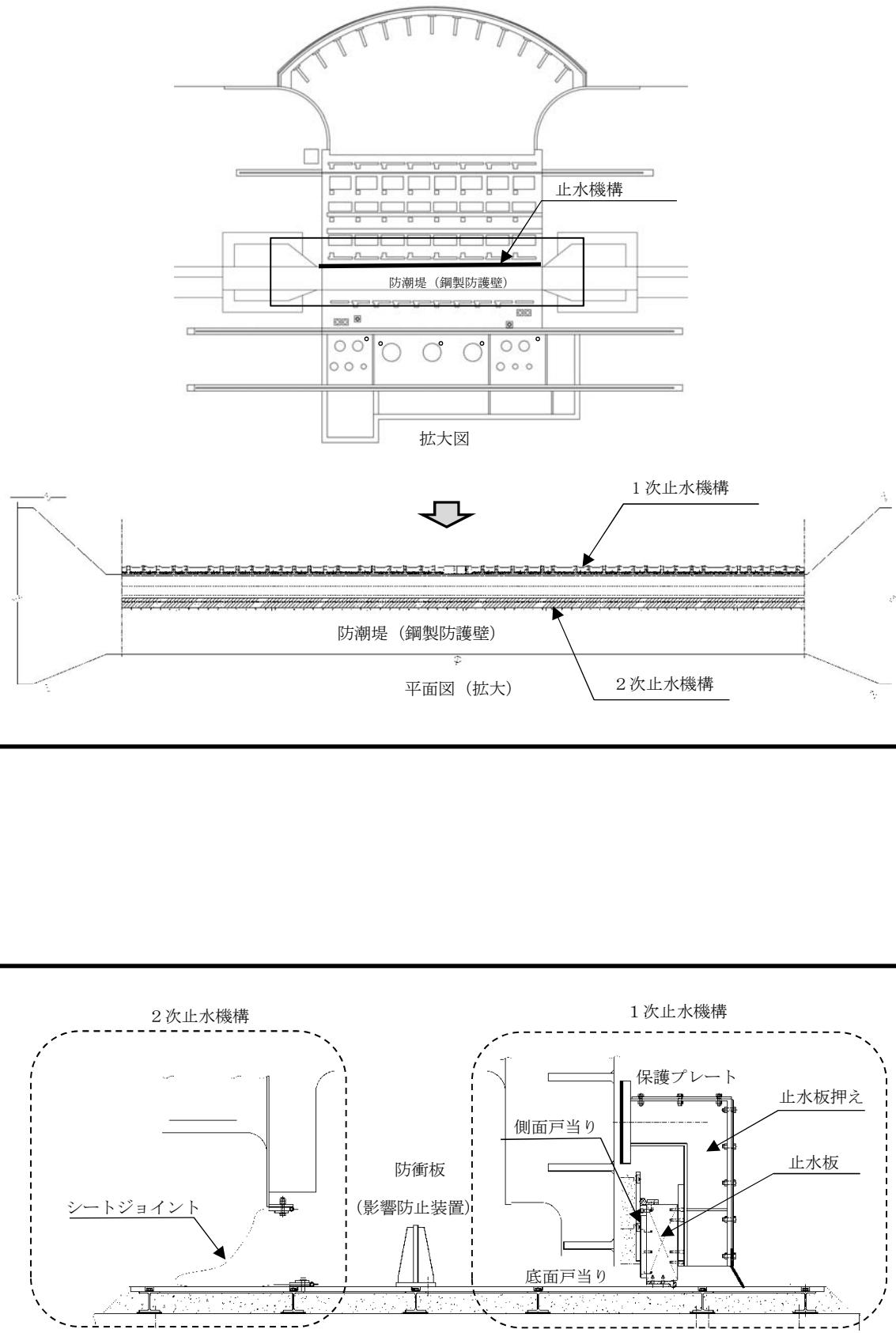
図2-2 止水機構の設置位置及び構造図
