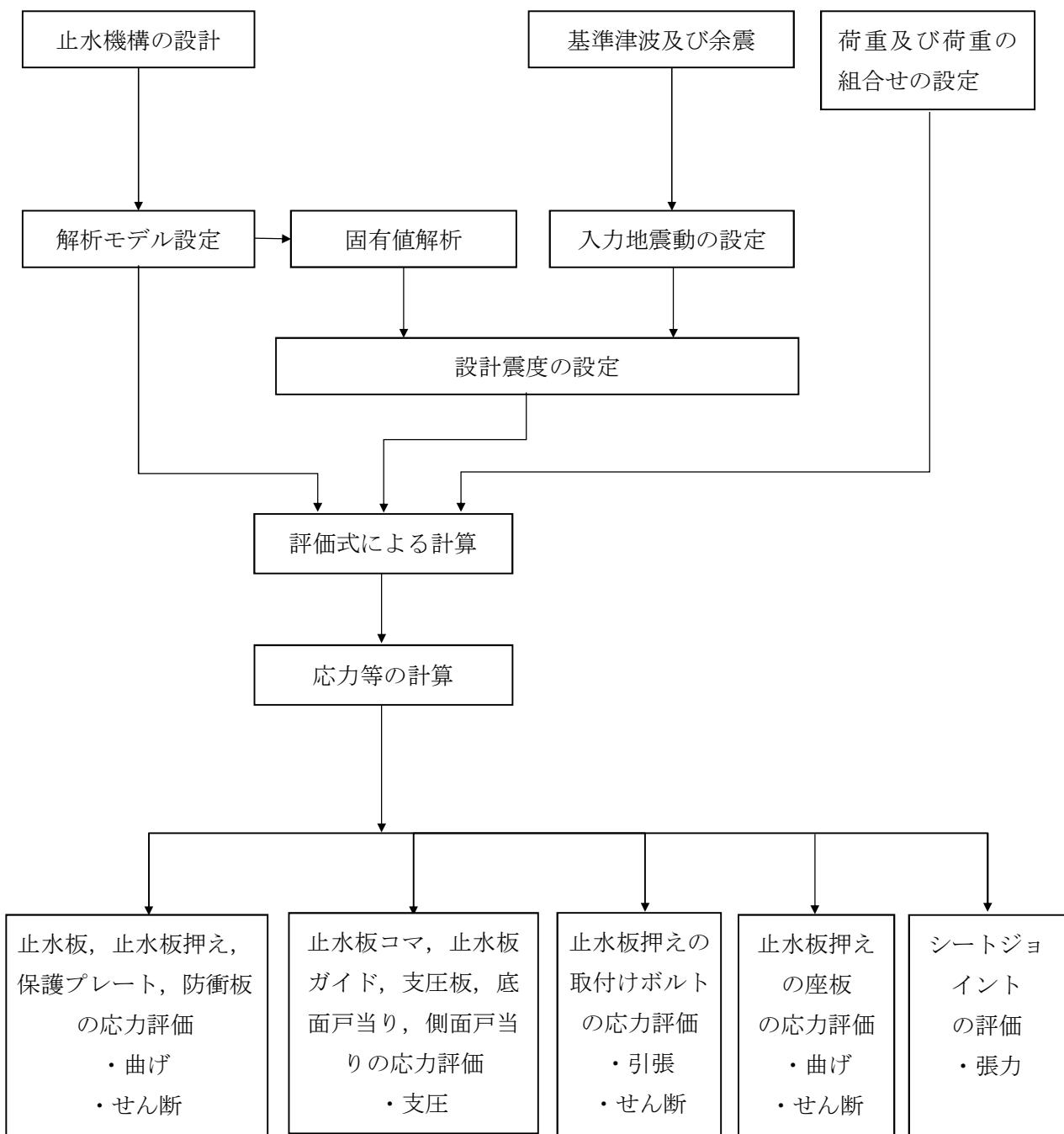
図 2-3 強度評価フロー
