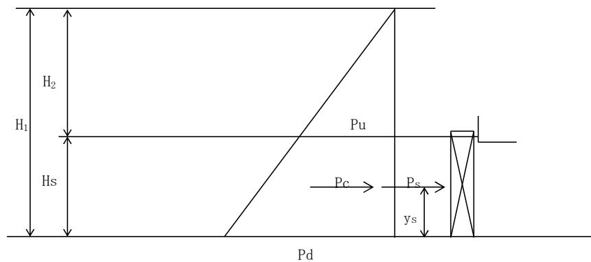
図 5-1 静水圧の荷重作用図
