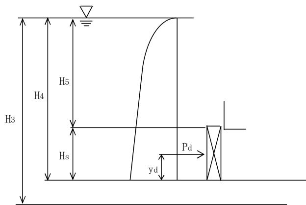
図 5-2 動水圧の荷重作用図
