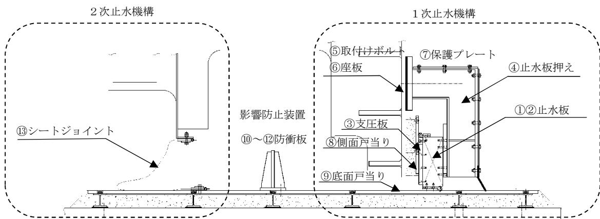
図3-1 止水機構の評価部位
