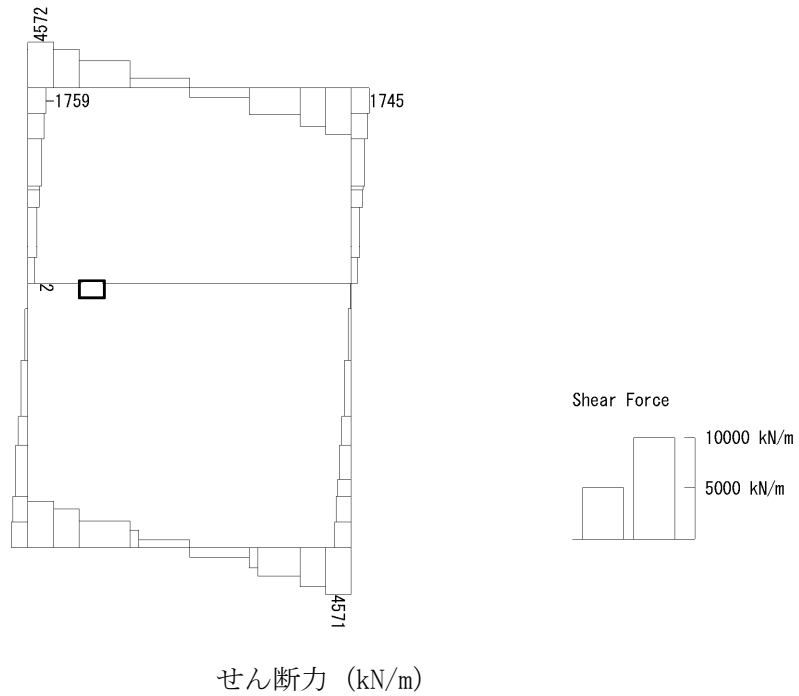
図 6.4-25 (7) B4F 中壁鉄筋の曲げ軸力照査に用いる断面力図 ( S_s - D1 (H+, V+), t = 68.74s ) (検討ケース②: 地盤物性のばらつきを考慮 (+1 \sigma ) した解析ケース)
