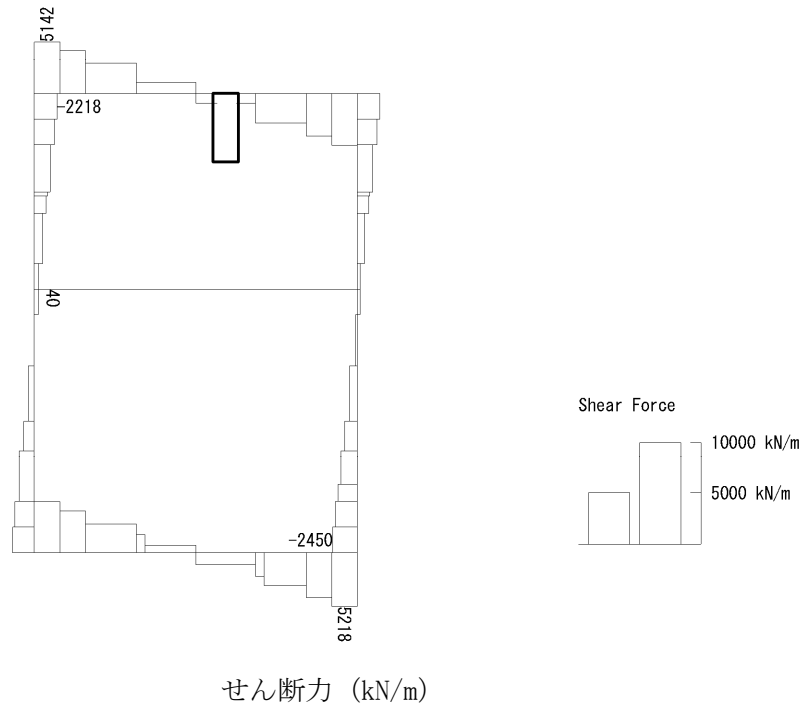
図 6.4-22 (7) B4F 側壁コンクリートの曲げ軸力照査に用いる断面力図 ( S_s - D1 (H+, V+), t = 68.74s ) (検討ケース②: 地盤物性のばらつきを考慮 (+1 \sigma ) した解析ケース)
