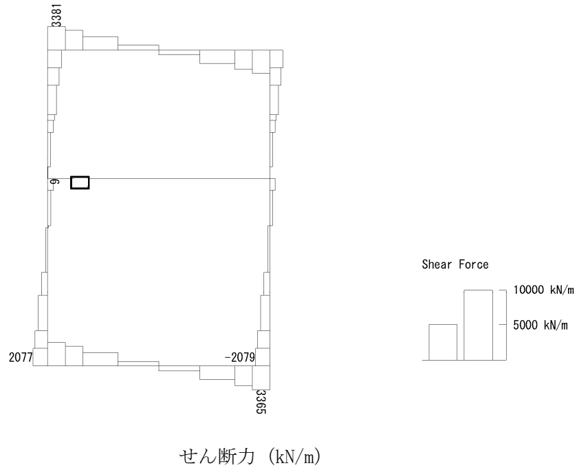
図 6.4-25 (12) ピット部中壁鉄筋の曲げ軸力照査に用いる断面力図 ( S_s - D1 (H-, V-), t = 60.50s ) (検討ケース②: 地盤物性のばらつきを考慮 ( +1\sigma ) した解析ケース)
