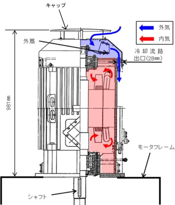
図 2.3-2 非常用ディーゼル発電機（高圧炉心スプレイ系ディーゼル発電機を含む。）用海水ポンプ原動機の冷却方式
