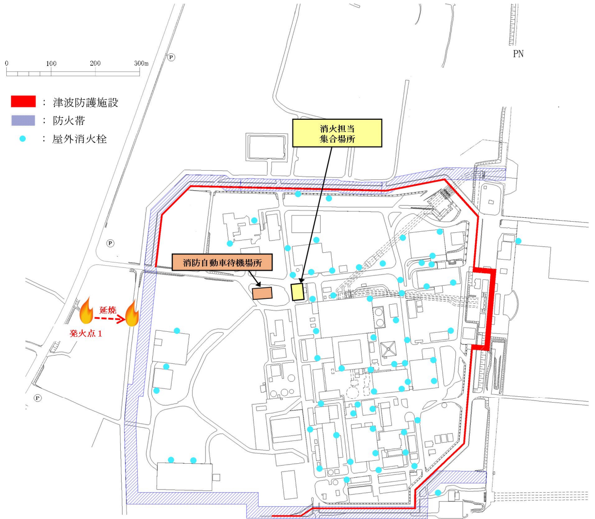
図 2. 1. 2-3 屋外消火栓の設置位置
