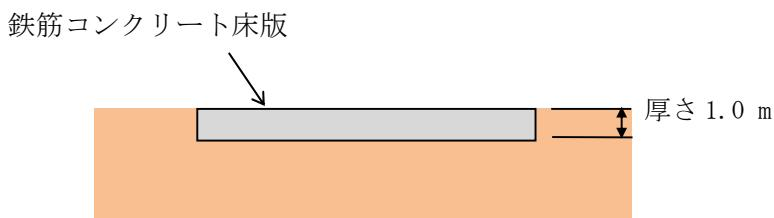
第3-1図 鉄筋コンクリート床版の概要
