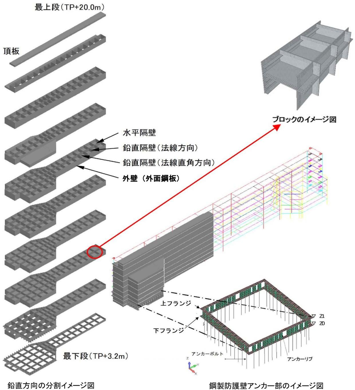
図 2-6 鋼製防護壁の上部構造の構造概要図
