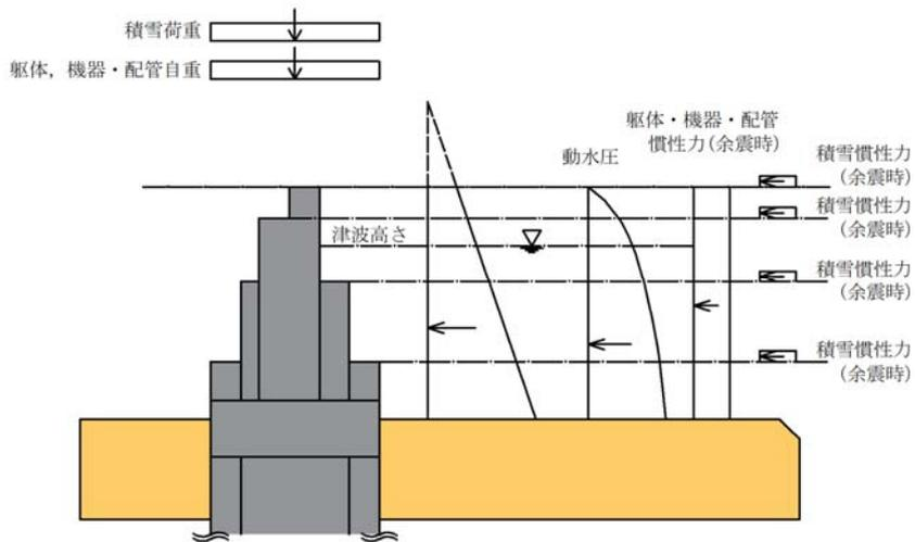
図 3-4 (1) 基準津波時の作用図
