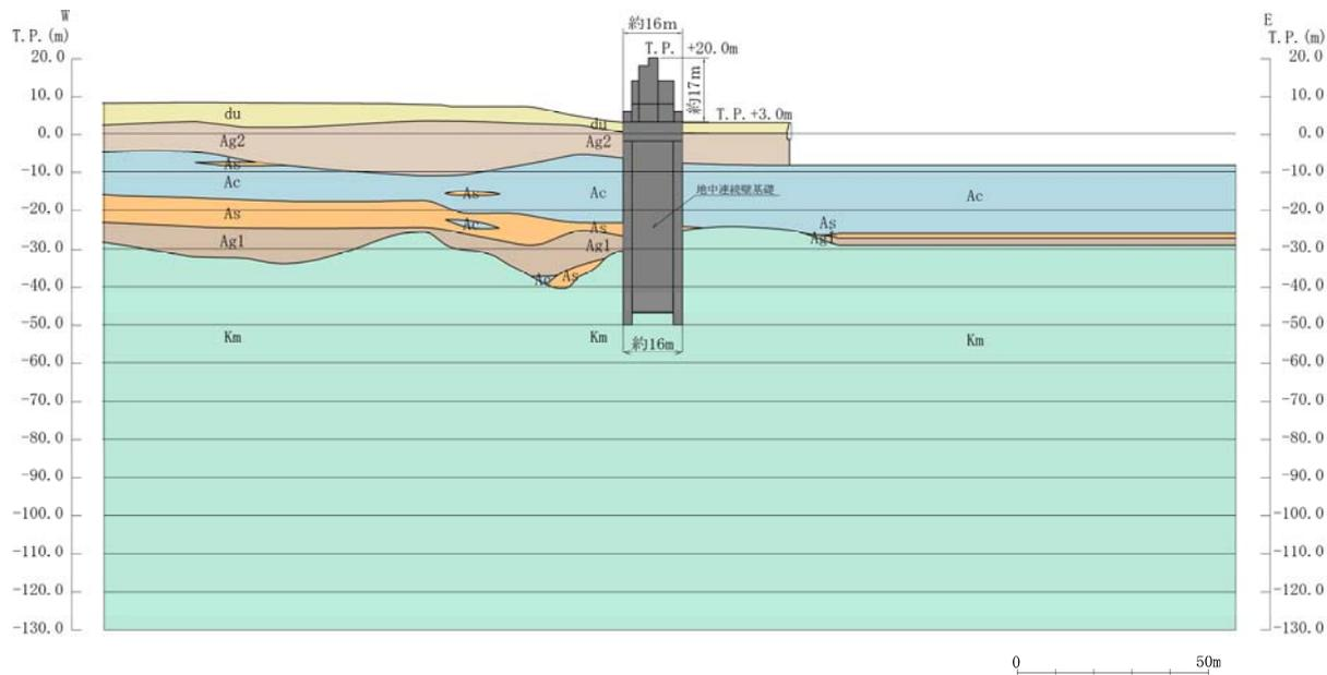
図 3-2 (3) 鋼製防護壁断面図 (③-③断面)
