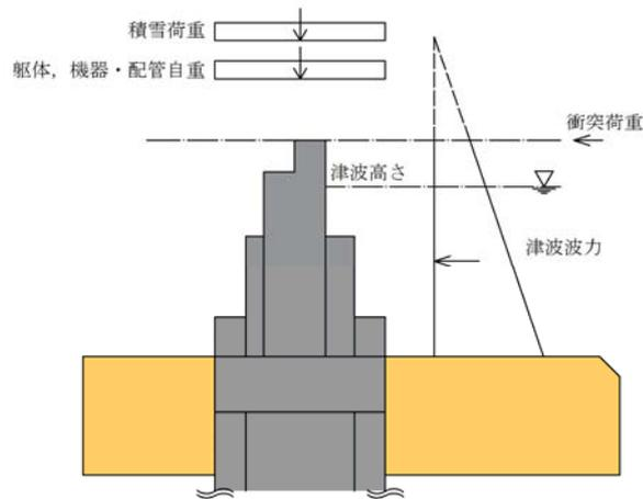
図 3-3 (1) 基準津波時の作用図
