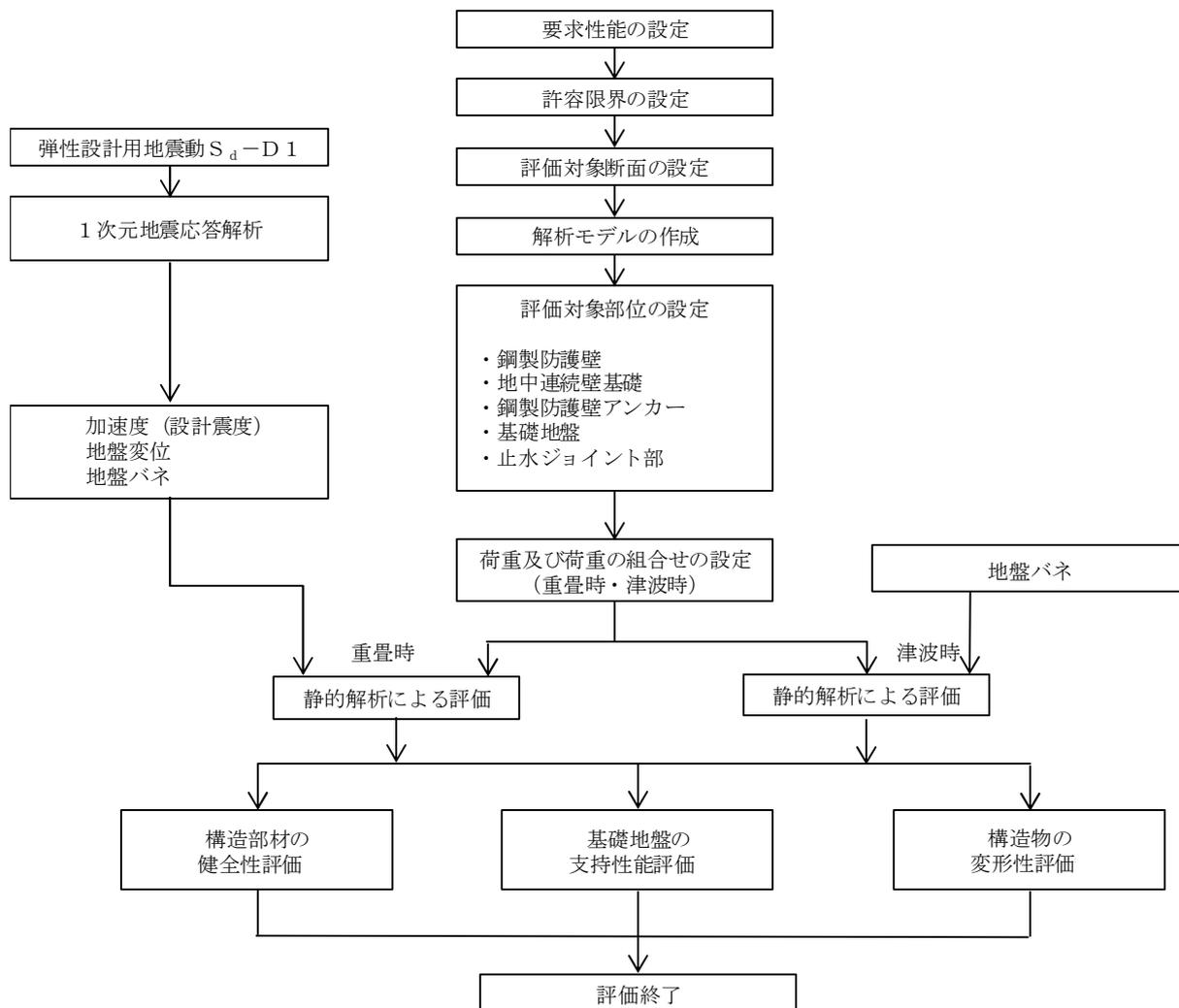
図 2-10 鋼製防護壁の耐津波評価フロー
