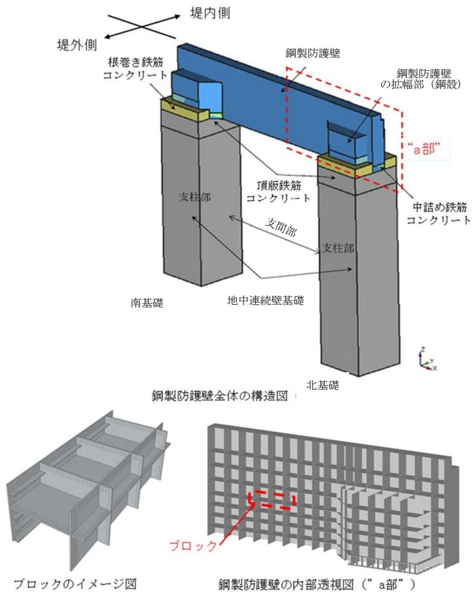
図 2-5 鋼製防護壁全体の構造概要図
