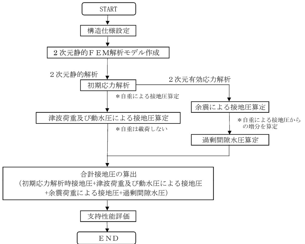
図 3-14 接地圧の算出フロー
