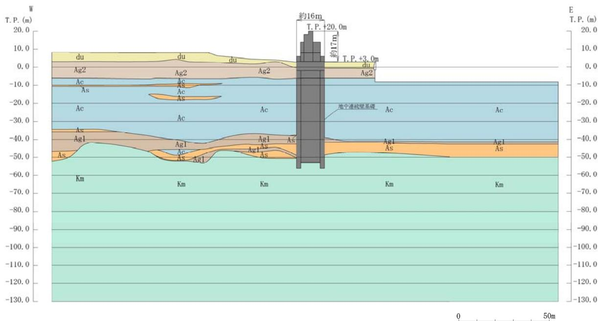
図 3-2 (2) 鋼製防護壁断面図 (②-②断面)
