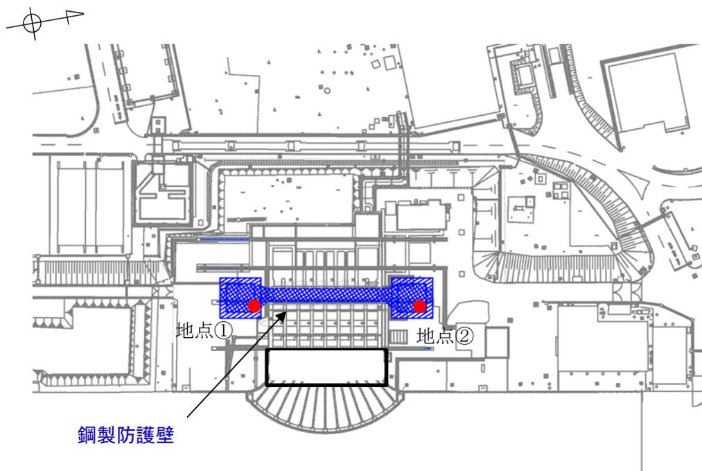
図 3-7 1次元有効応力解析実施位置図
