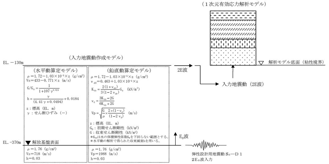
図 3-9 入力地震動算定の概念図
