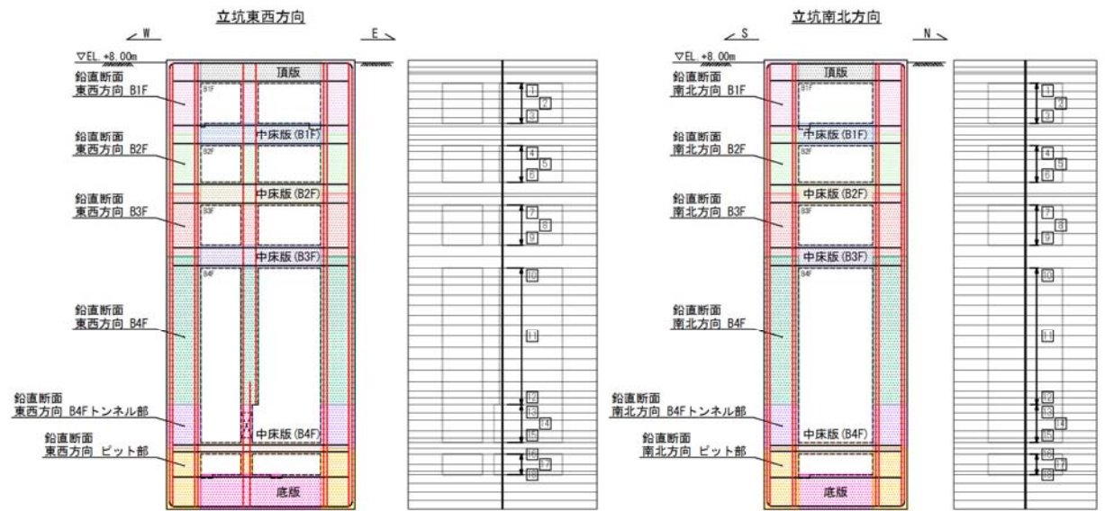
鉛直断面照査位置図（曲げ）
