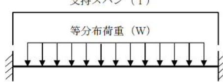
図 3.4-1 原子炉建屋原子炉棟 屋根スラブ 評価モデル図(両端固定梁)
