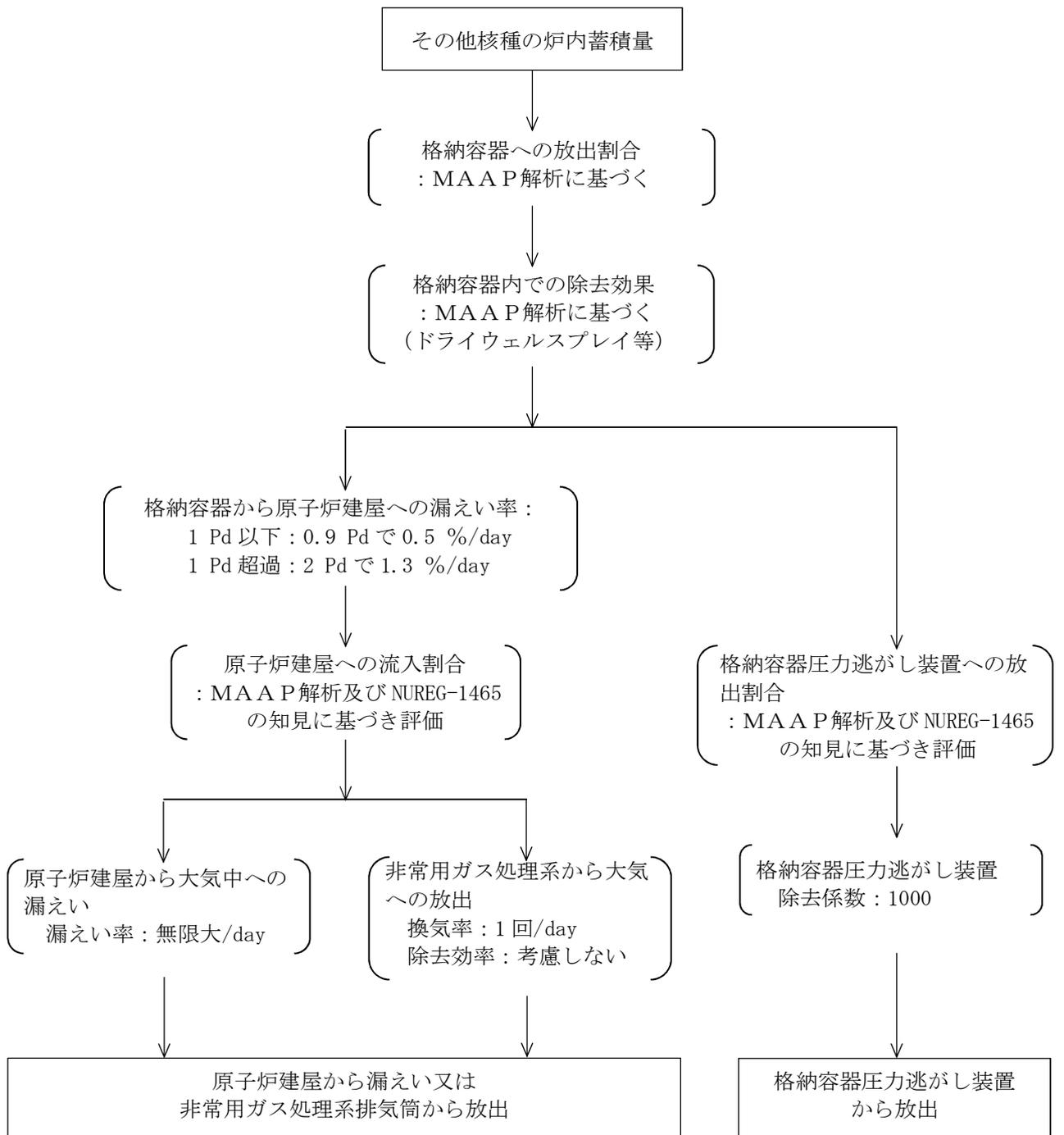
図 4-28 その他核種の大気放出過程 (炉心の著しい損傷が発生した場合)
