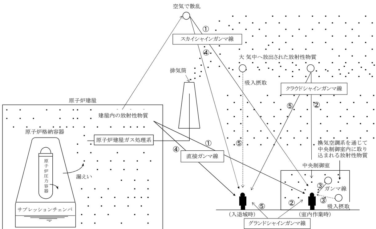
図 4-3 中央制御室の居住性に係る被ばく経路イメージ
