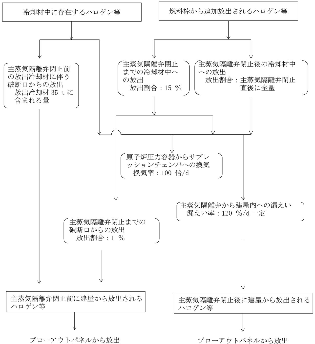
図 4-24 主蒸気管破断時のハロゲン等の大気放出過程（設計基準事故時）
