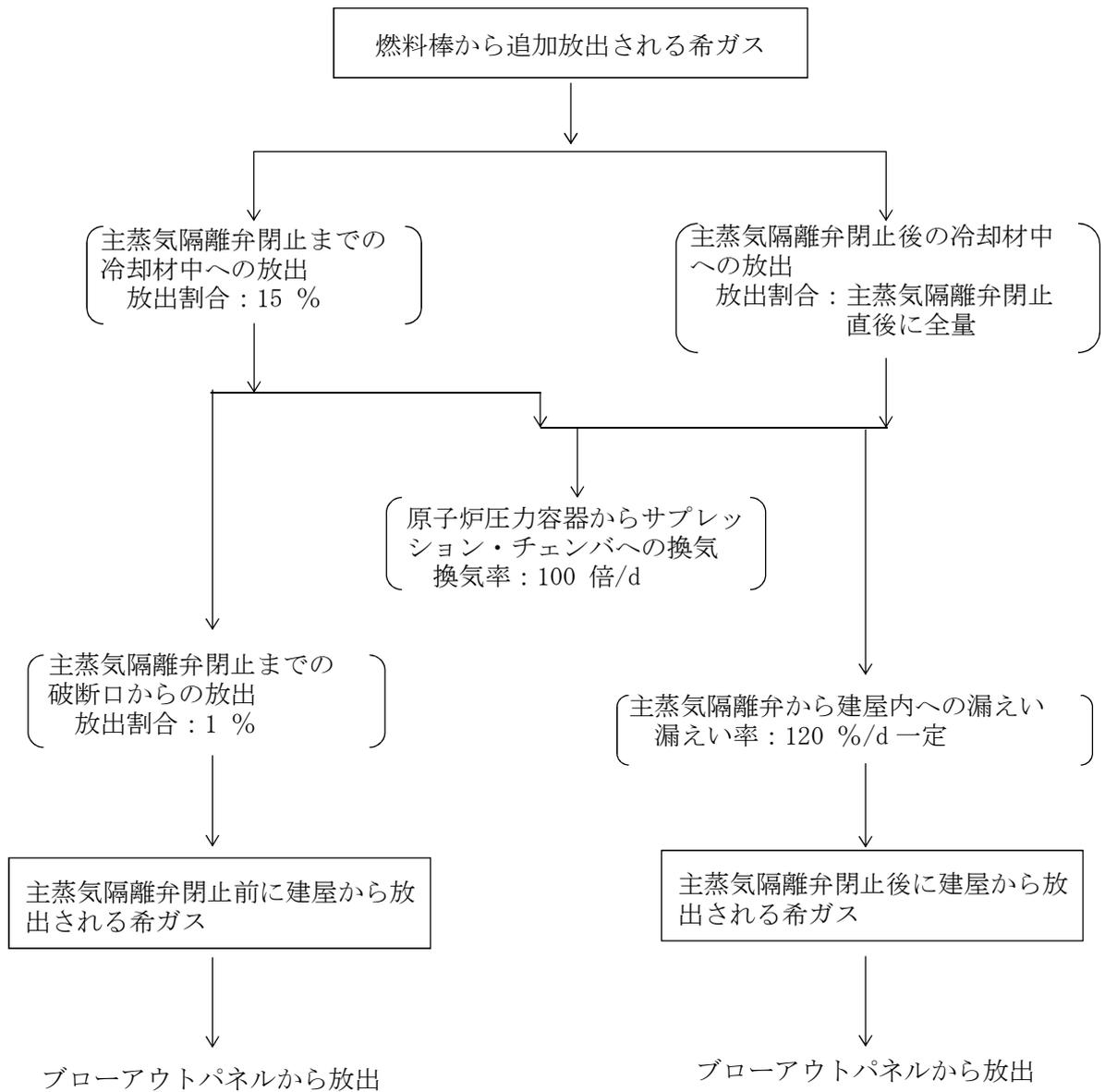
図 4-23 主蒸気管破断時の希ガスの大気放出過程（設計基準事故時）
