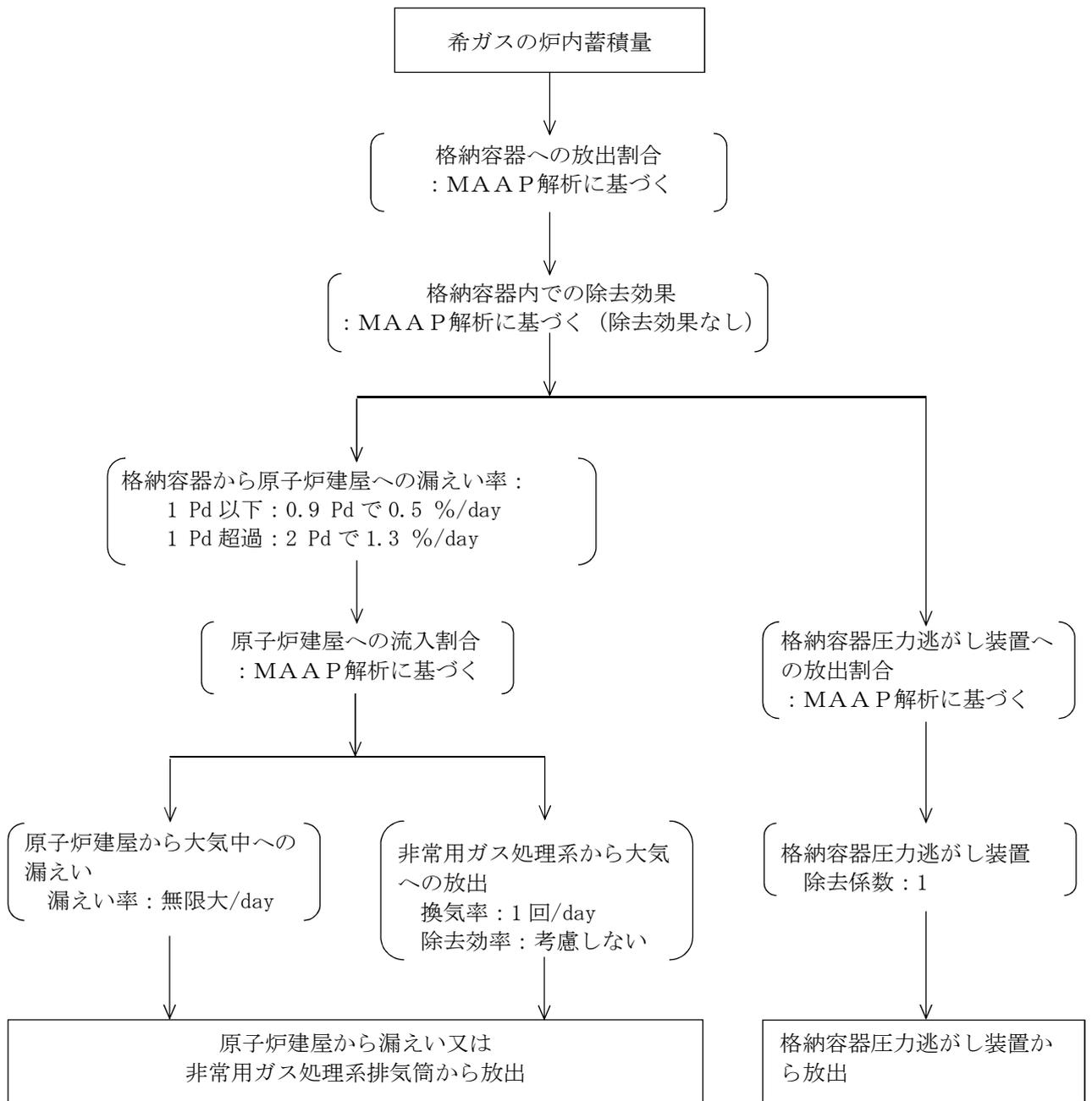
図 4-25 希ガスの大気放出過程 (炉心の著しい損傷が発生した場合)
