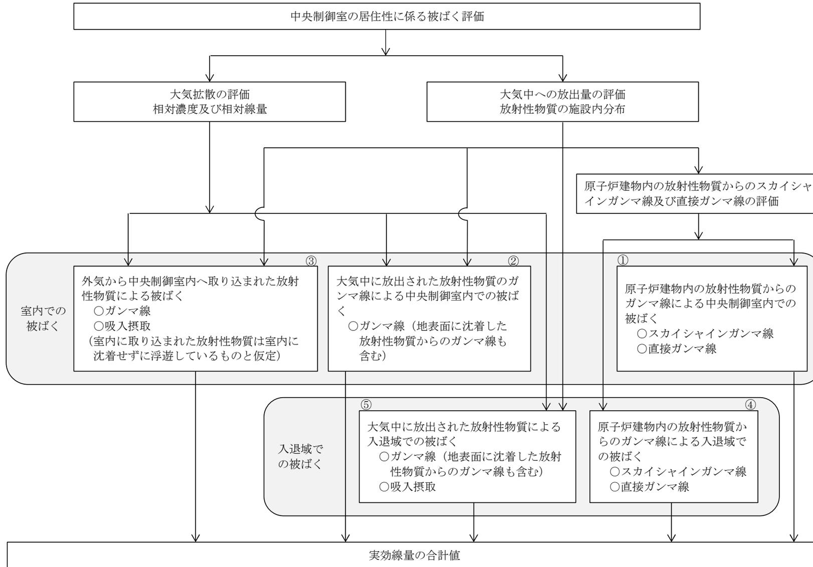
図 4-2 中央制御室の運転員の被ばく経路
