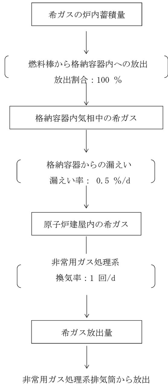
図 4-21 原子炉冷却材喪失時の希ガスの大気放出過程（設計基準事故時）
