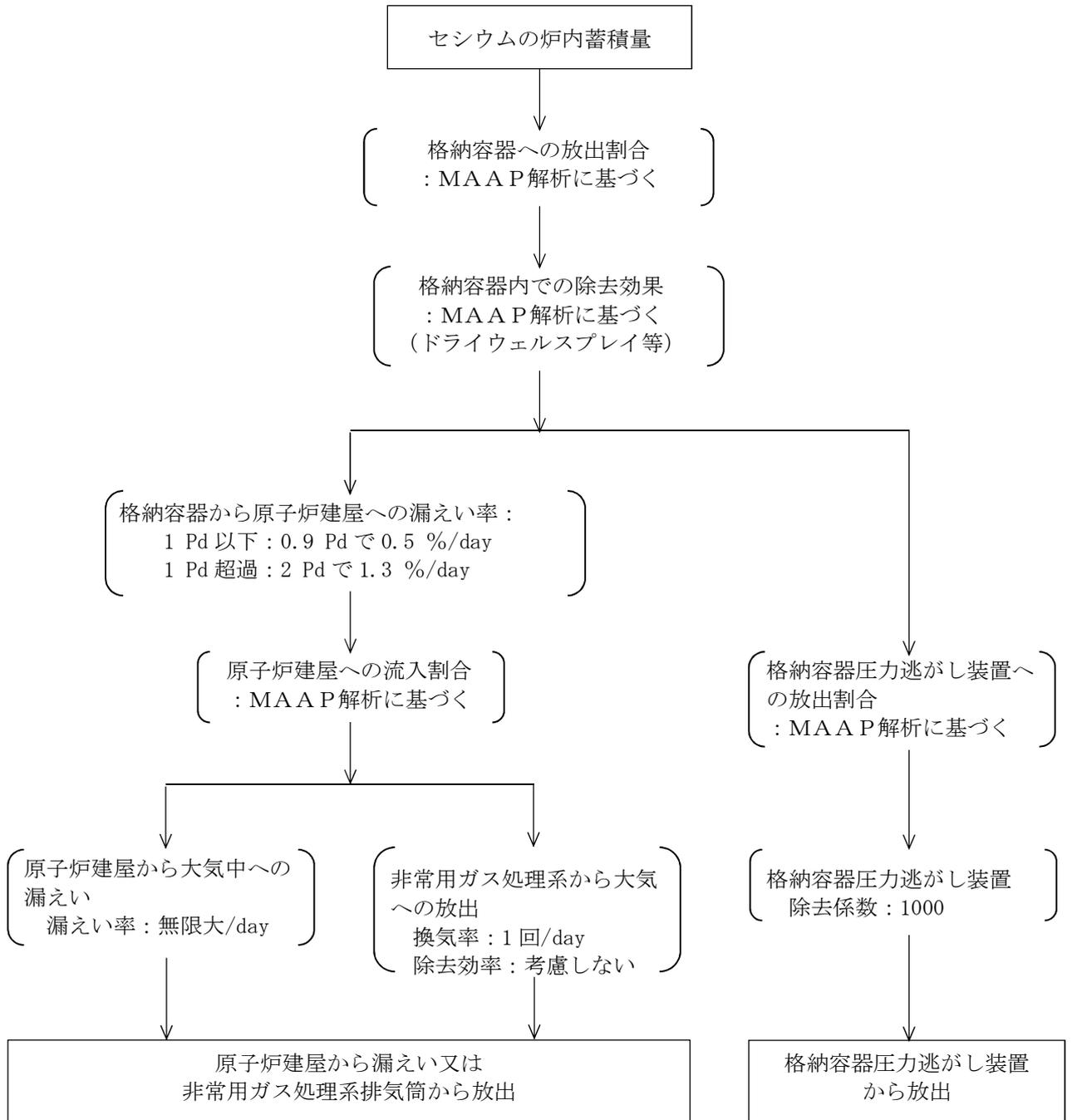
図 4-27 セシウムの大気放出過程 (炉心の著しい損傷が発生した場合)
