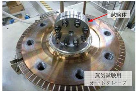
図3-4 改良E P D M製シール材の性能確認試験装置
