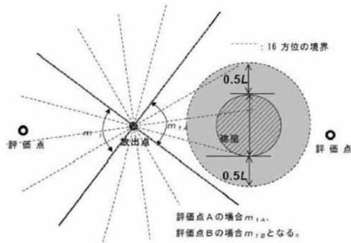
注: Lは、風向に垂直な建物の投影面の高さ又は投影面の幅のうちの小さい方
