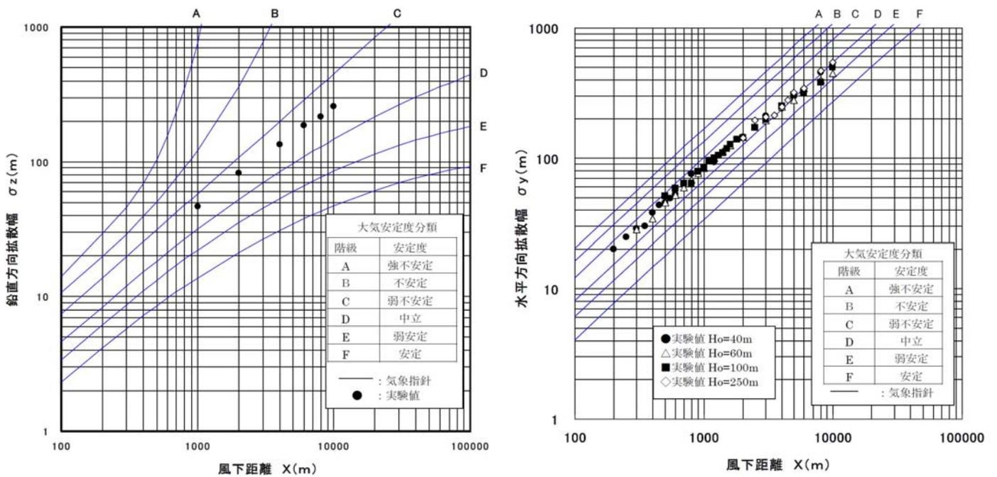
注) 鉛直方向拡散幅は大気安定度が中立に相当する値 (C~D) になっている。水平方向拡散幅もほぼ大気安定度が中立に相当する値 (C~D) になっている。
