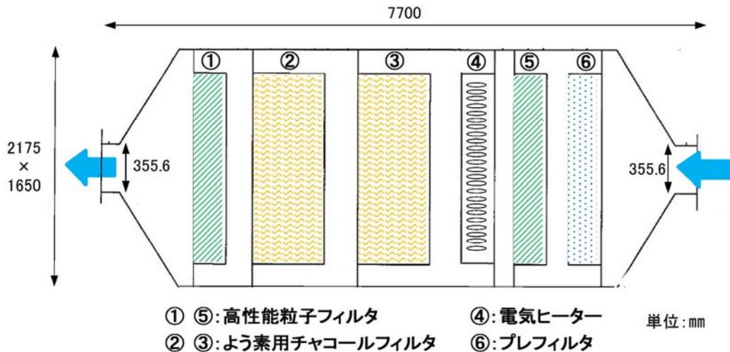
第3-3図 緊急時対策所非常用フィルタ装置の概要図
