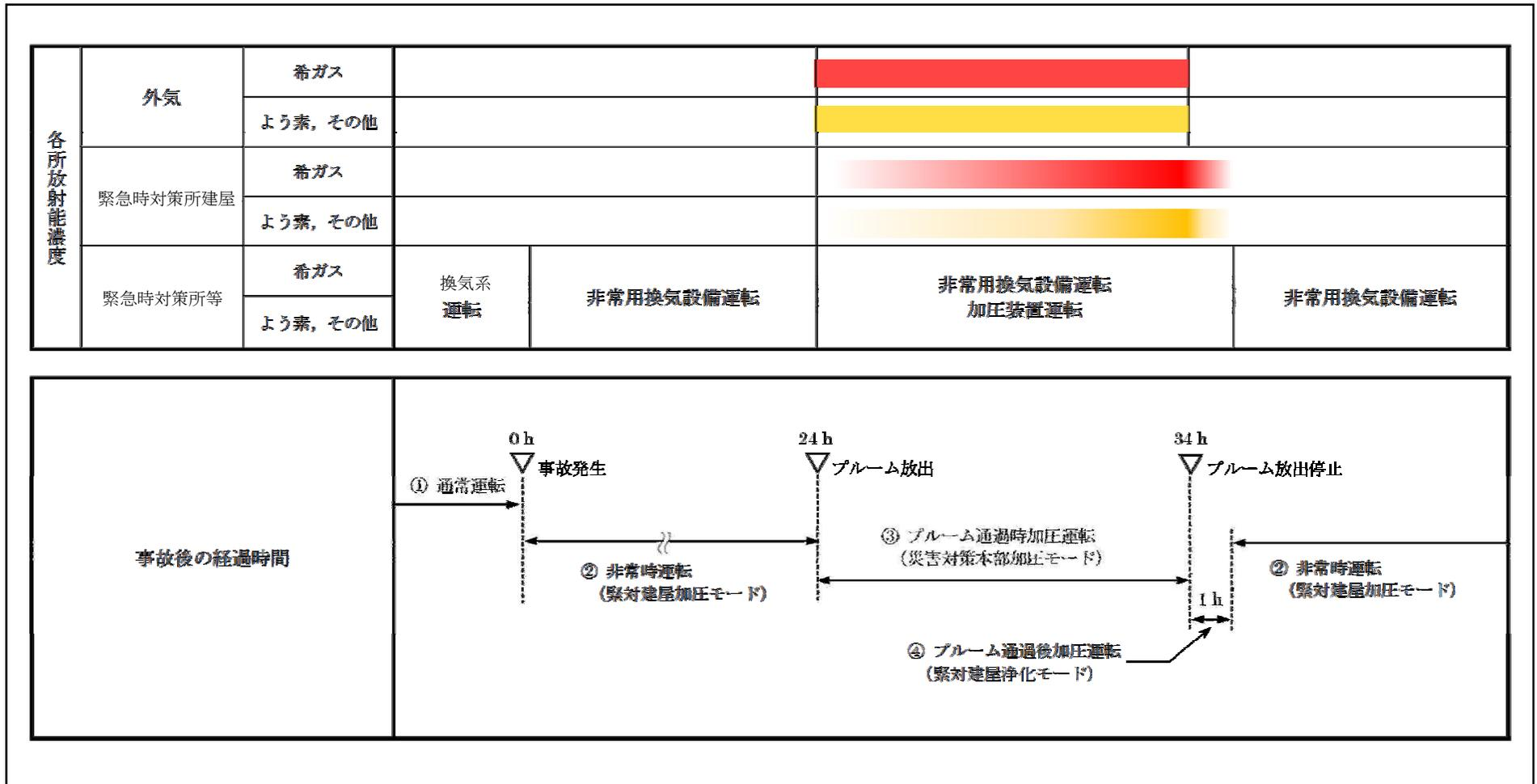
第3-5図 緊急時対策所換気系等の運用イメージ
