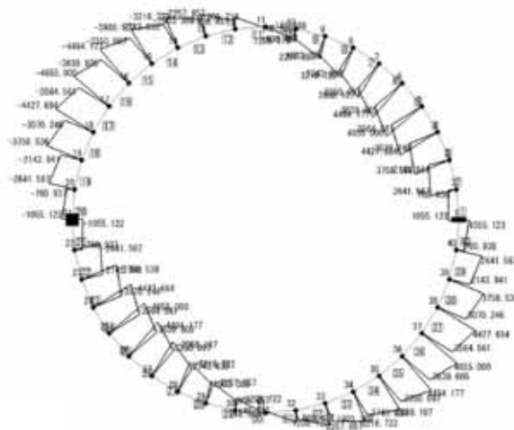
図 3-8 水平断面のせん断力照査における最大照査値の評価時刻での断面力 (下部, S_s - D 1 , t = 53.93 s)
