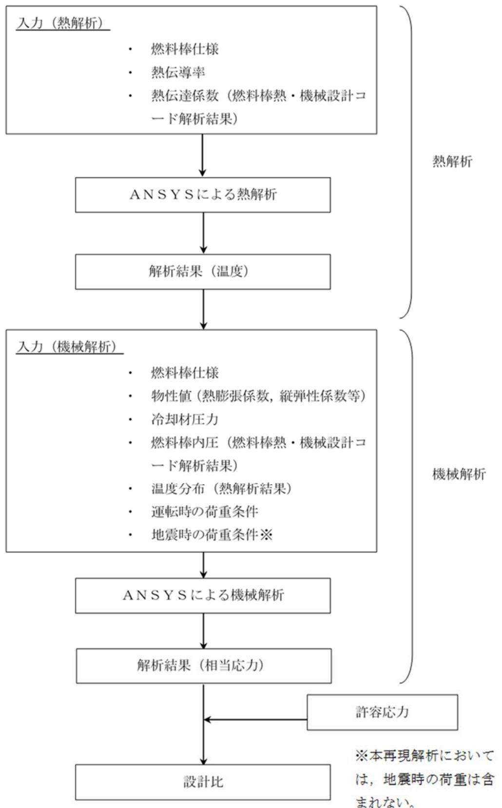
添付 8-1図 下部端栓溶接部の応力評価のフロー
