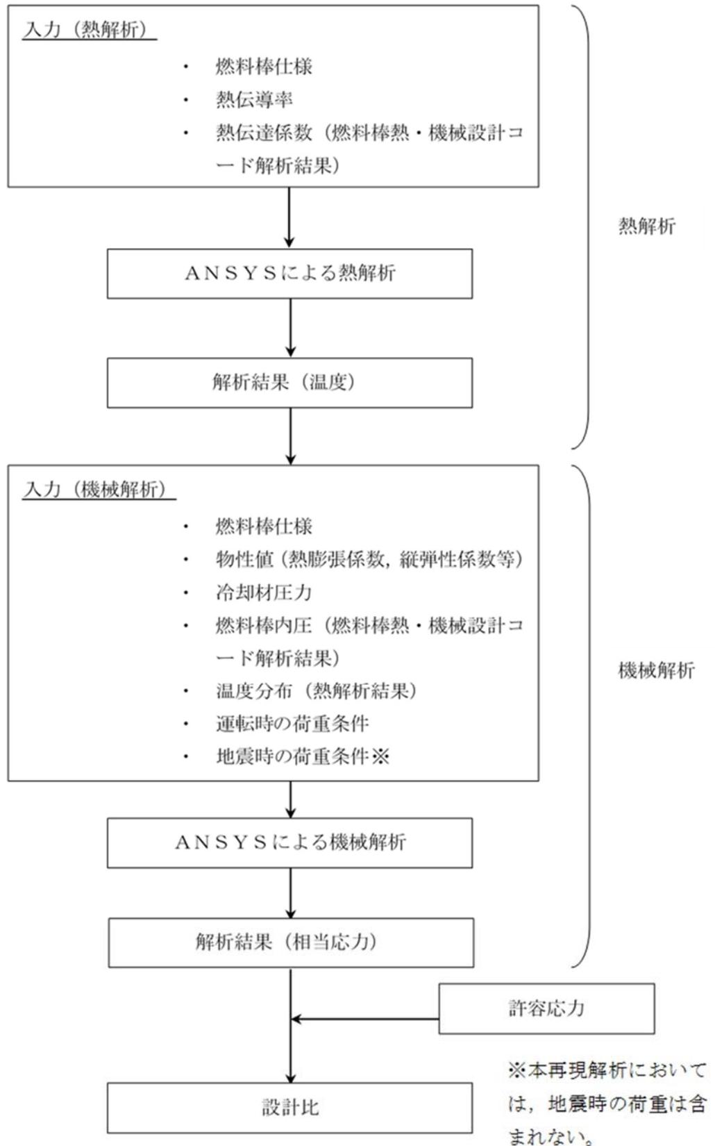
添付8-1図 下部端栓溶接部の応力評価のフロー
