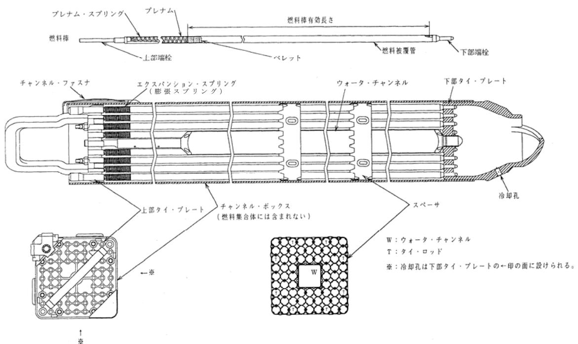
添付1-3図 燃料集合体の構造図（9×9燃料（B型））
