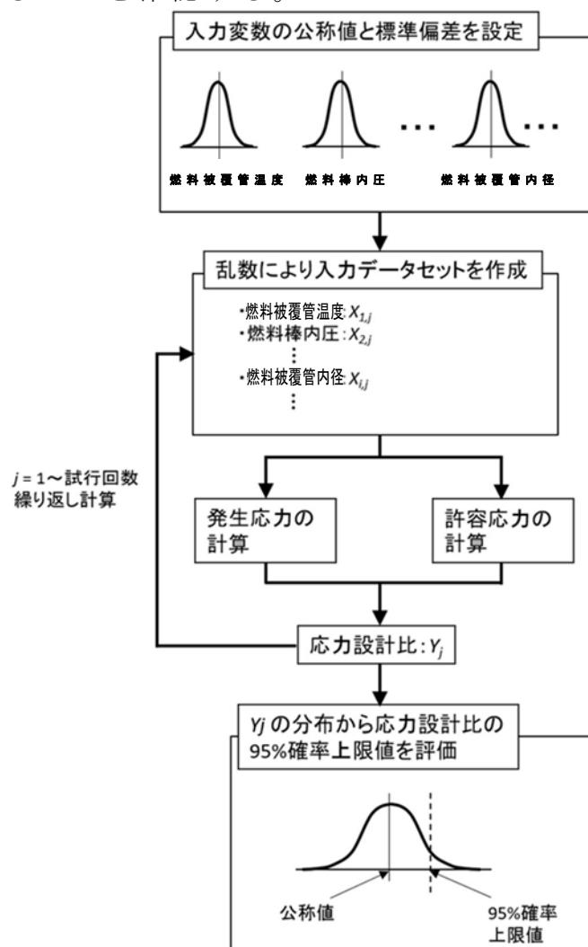
添付 7-1 図 モンテカルロ法による統計処理の概要フロー
