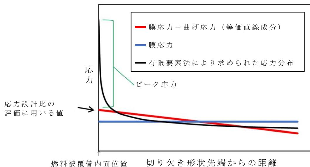
添付2-2図 応力分布と等価線形処理結果の模式図
