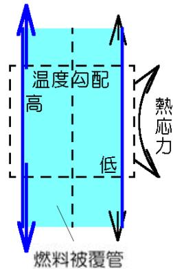
(7) 膨張スプリング等による軸方向荷重に基づく応力
