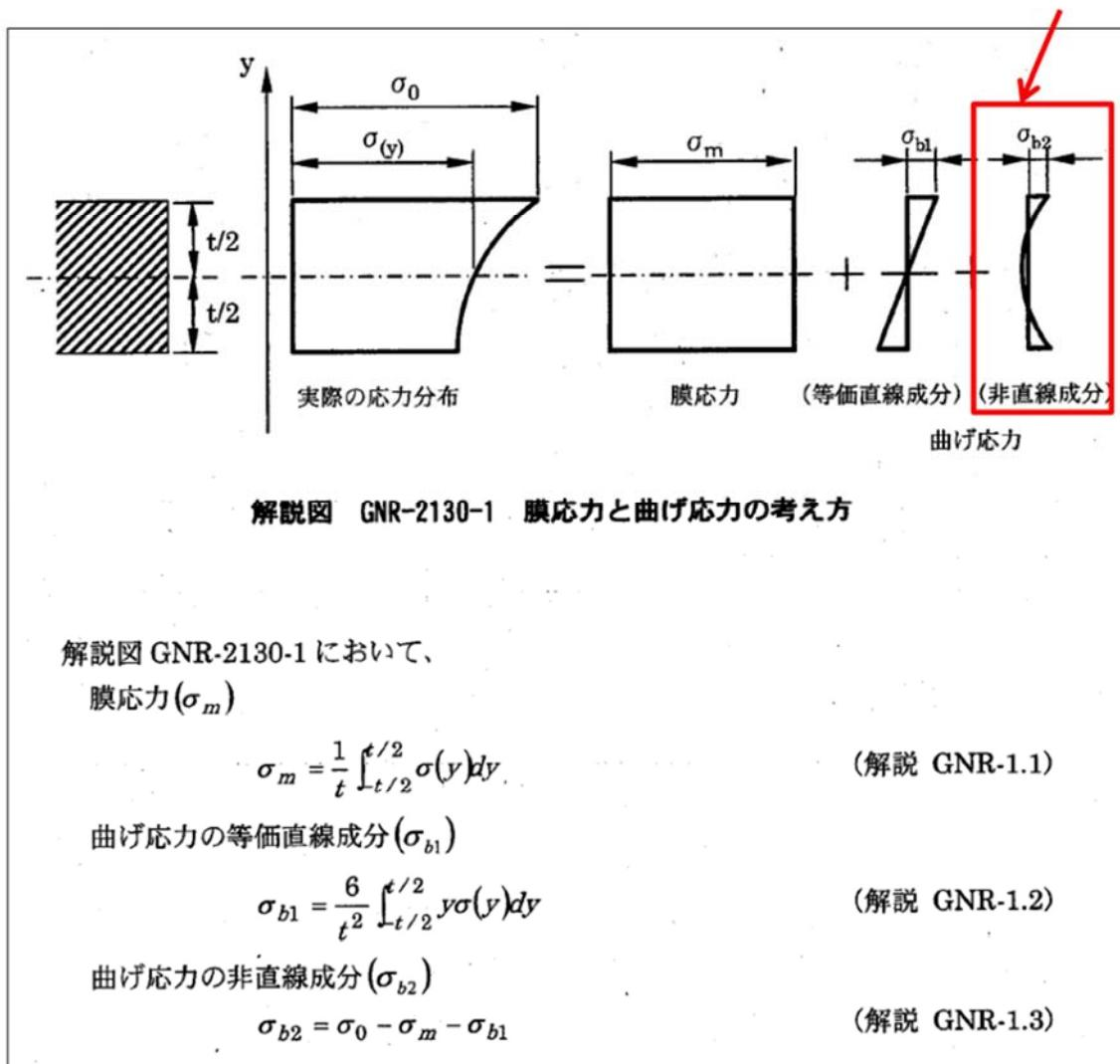
添付2-3図 応力の考え方の模式図 (J S M E S NC1-2005/2007<sup>[3]</sup>から抜粋)
