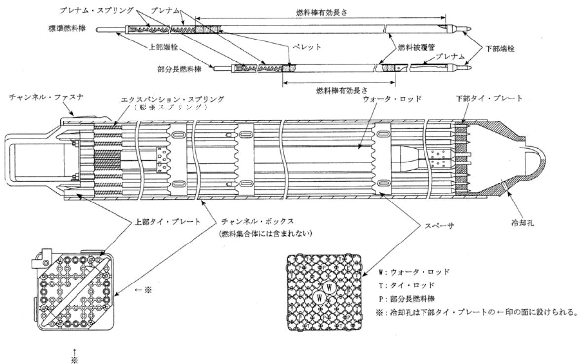
添付1-2図 燃料集合体の構造図（9×9燃料（A型））
