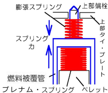
(8) ウォータ・チャンネルと燃料被覆管の熱膨張差による応力
