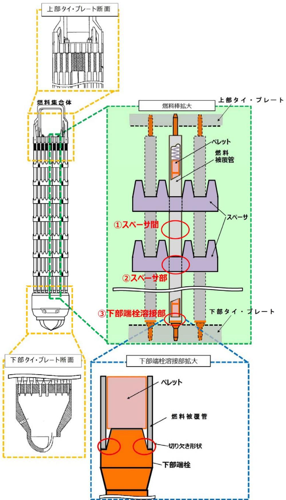
添付 9-1 図 評価部位の概要図
