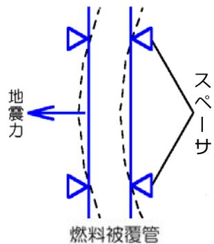
(11) チャンネル・ボックスの水平地震力によるたわみに基づく応力
