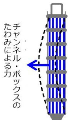
(12) 鉛直方向地震加速度に基づく応力
